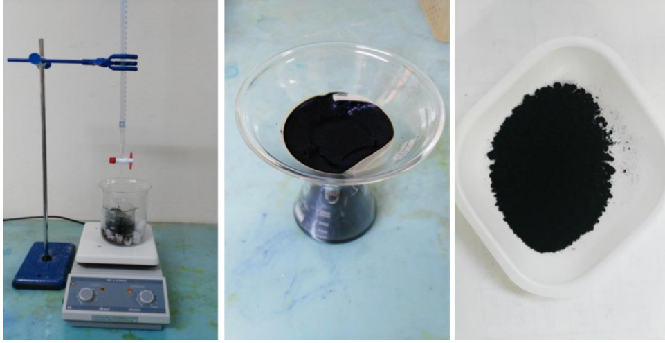
Şekil 4.3. Adsorbanların sentez aşamaları
