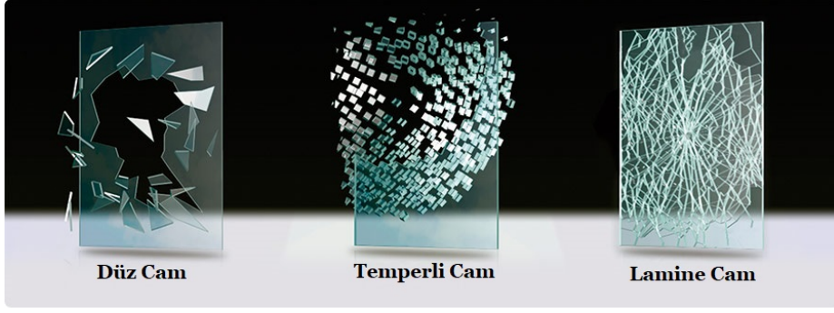
Şekil 2.9: Farklı cam tiplerinin kırılma davranışları (Url-8, 2020).
