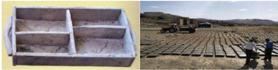
Şekil 2.2 Dört Gözlü Ahşap Kerpiç Kalıbı (solda) ve Kalıptan Çıkarılan Kerpiçin Güneşte Kurutulması (sağda) (Gündoğdu, 2019)
