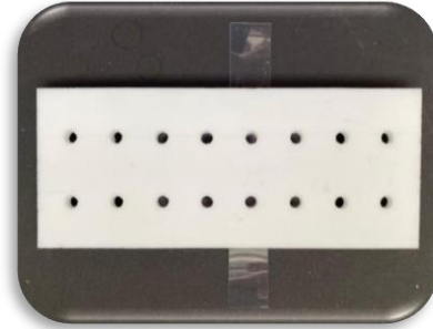
Resim 3.17. Teflon kalıba restoratif materyalin yerleştirilmesinden önce kalıbın altına siman camı ve şeffaf bant yerleştirilmesi
