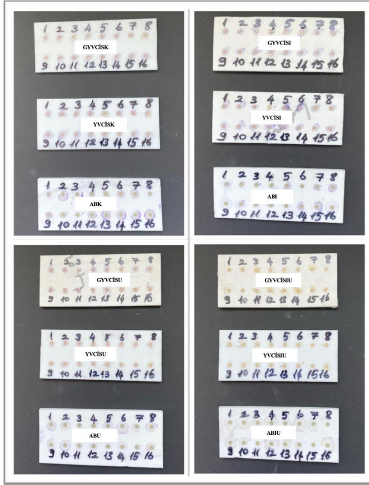
Resim 3.25. Vicker's sertlik ölçümü için teflon kalıp kullanılarak hazırlanan örnekler (Grup 1-12)
