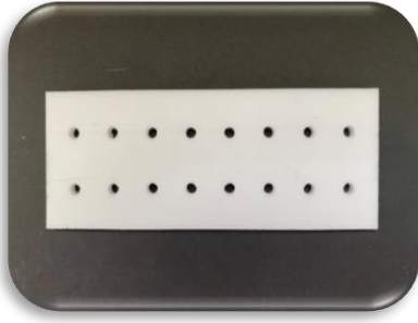
Resim 3.16. 4 mm \varnothing unda ve 4 mm derinliğinde delikler hazırlanmış teflon kalıp
