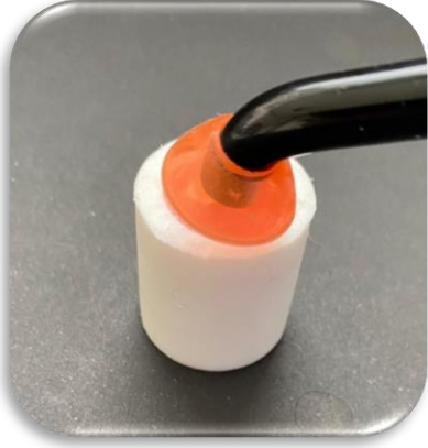
Resim 3.37. Akışkan bulk-fill kompozit rezinin LED ışık cihazı ile polimerize edilmesi
