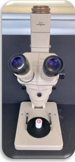
Resim 3.49. Örneklerin kırılma yüzeylerinin stereomikroskop kullanılarak x40 büyütmeyle incelenmesi
