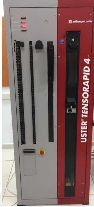
Resim 3.7. İplik mukavemeti test cihazı
