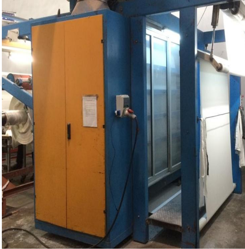
Resim 3.4. Memnun melisa model zımpara makinası
