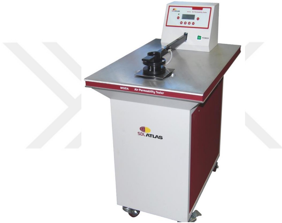
Resim 3.11. Hava geçirgenliği ölçüm cihazı (SDL Atlas, 2003)
