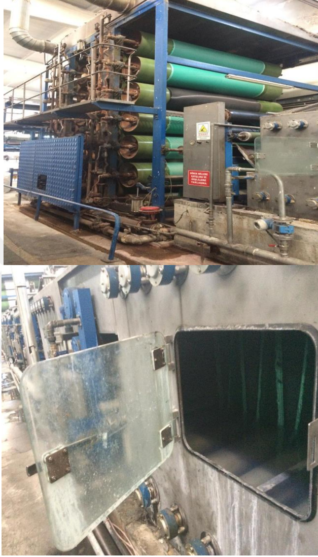
Resim 3.3. SAGA model merserize makinası
