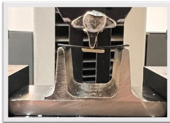
Şekil3.22. Üç nokta eğme testinin uygulanması ve porselenin metalden ayrılmasının gösterilmesi
