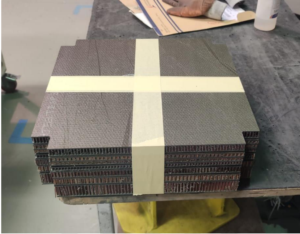
Şekil 6.23: Üretim sonrası kesim işlemleri tamamlanmış sandviç kompozit deney plakları.
