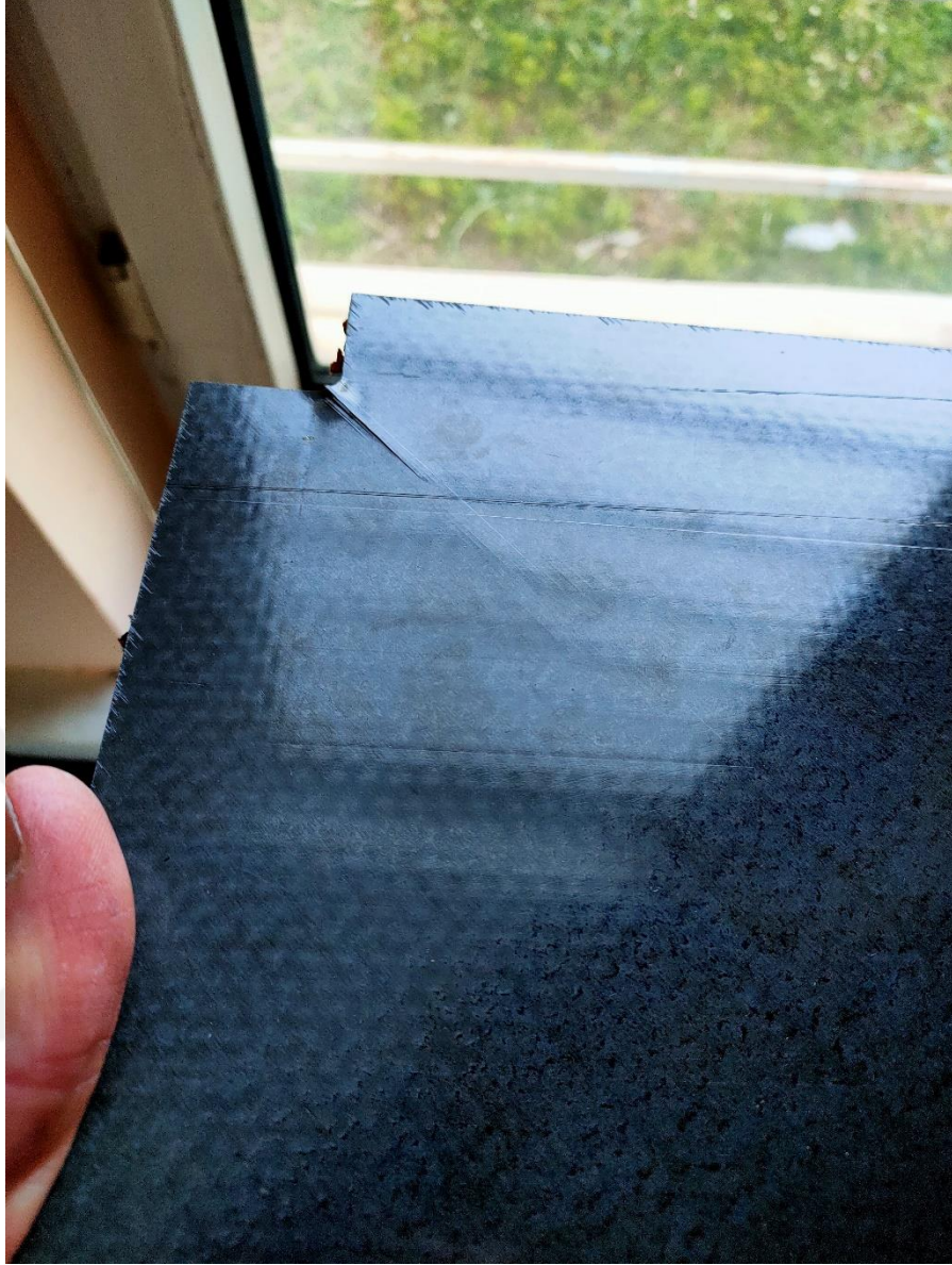
Şekil 6.36: HJ53BAP502 nolu plakada deney sonrası oluşan yüzey çatlağı.
