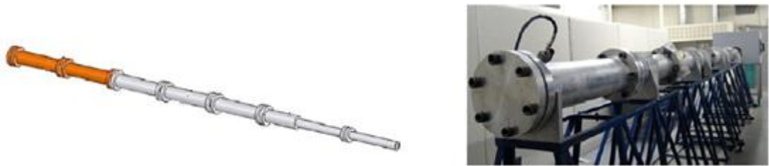
Şekil 2.13 : Şok tüpü diyagramı ve görseli [23].
