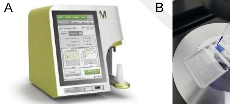
Şekil 2: Hücre sayımı için kullanılan ekipman A) Muse hücre analizatörü B) Tripan mavisi ile boyanmış hücrelerin hemasitometre ile sayımı
