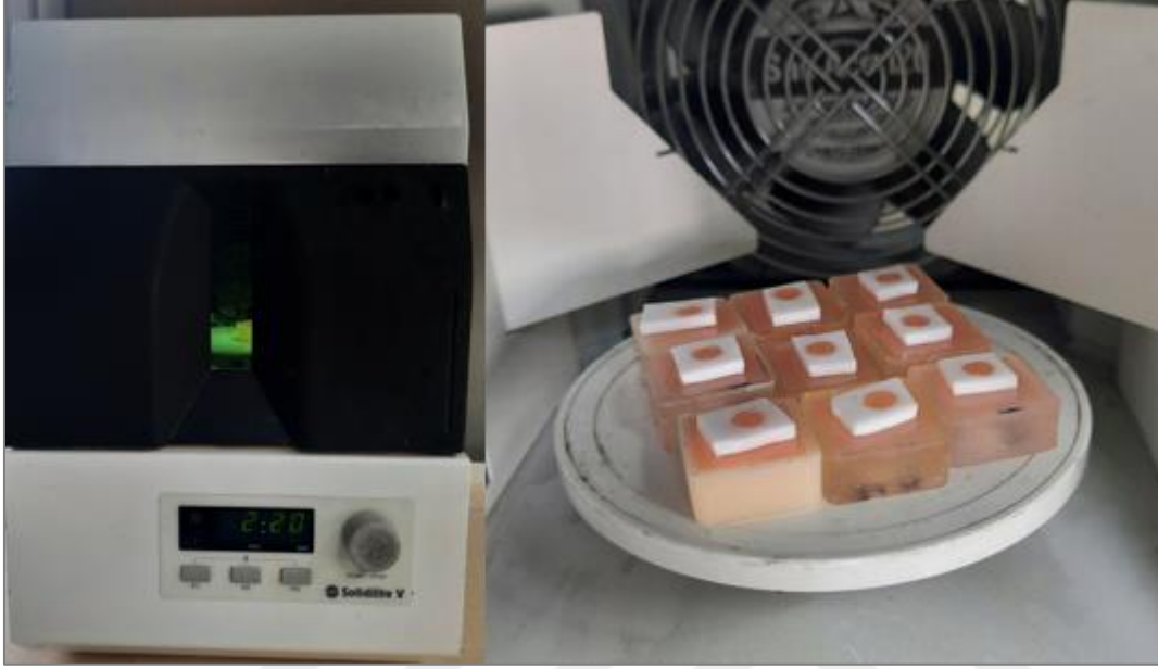
Resim 3.13. Polimerizasyon fırını ve polietilen kalıplar içerisinde yer alan dişeti kompozitinin polimerizasyonu
