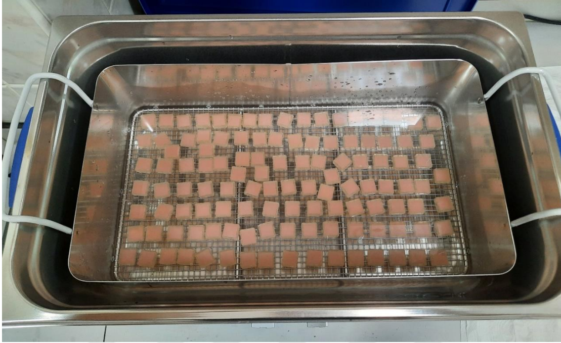
Resim 3.8. CAD/CAM PMMA kaide materyali test örneklerinin ultra sonik temizleme cihazında temizlenmesi
