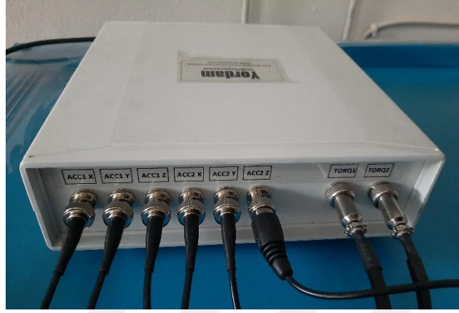
Şekil 3.34. Sekiz kanallı veri toplama kutusu.
