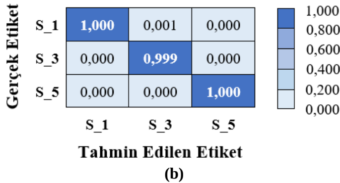
Şekil 4.54. x eksen için elde edilen en düşük ve en yüksek doğruluk oranlarına ait karışıklık matrisleri: (a) 300 devir/dk ve yuksüz (Test-1) durum ve (b) 600 devir/dk ve %20 yüklü (Test-2) durum.
