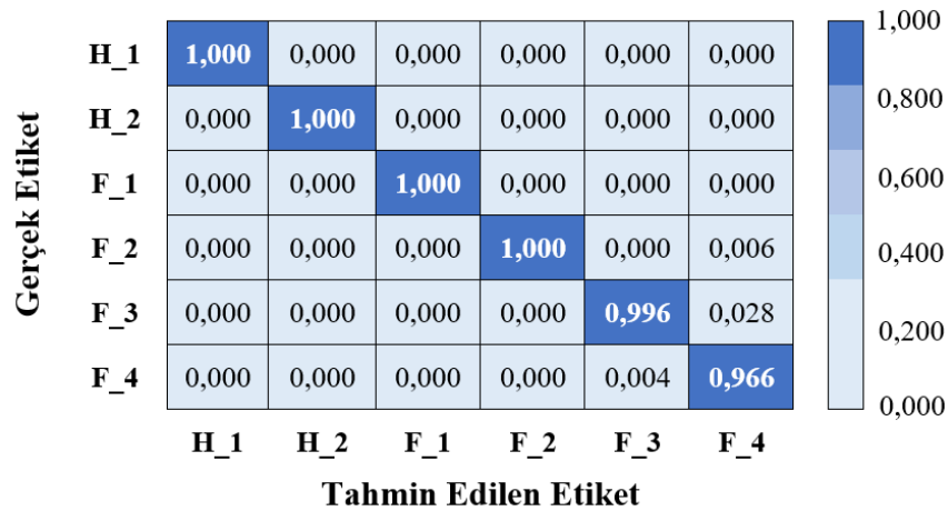
Şekil 4.33. CWRU veri seti için çizilen karışık matrisi.
