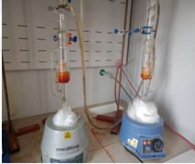
Şekil 3.4. Soxhlet Ekstraksiyon Sistemi Kullanılarak Numunelerin Ekstrakte Edilmesi İşlemi
