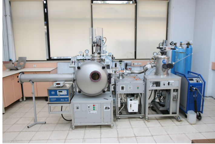
Şekil 4.1. Ark Ergitme Sistemi
