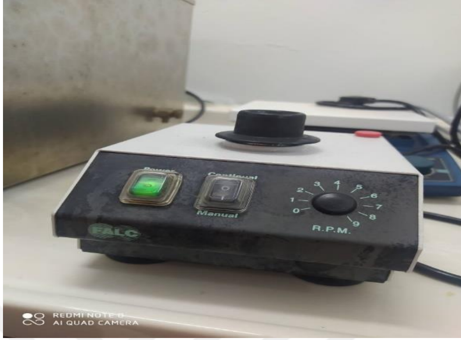
Şekil 8. Deneylerimizde kullandığımız Vorteks cihazı
