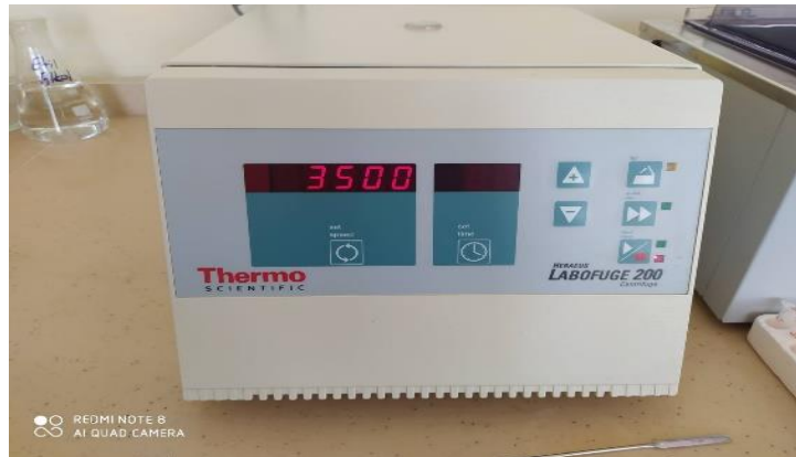
Şekil 7. Deneylerimizde çöktürme işlemi için kullandığımız santrifüj cihazı
