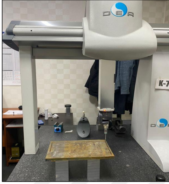
Şekil 5.9. Dikdörtgen kesitin ölçüm tamlığının CMM’de incelenmesi.
