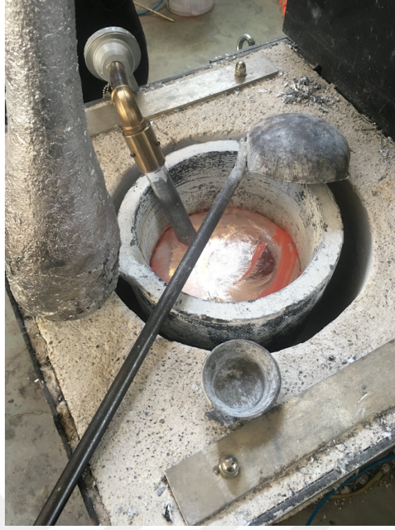
Şekil 2.5 : Gaz giderme öncesi seramik gaz giderme çanının ısıtılması.
