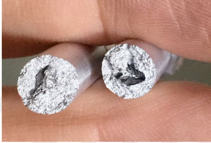
řekil 3.1 : 11B5 numunesine ait kırılma yzeyindeki inklzyon.
