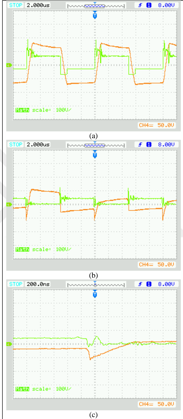
Şekil 4.26. DAB devresi D_1 = D_2 = 0.03 , D_3 = 0.15 DPS yönteminde iken (a) kaçak endüktans üzerindeki akım (yeşil)-gerilim (mavi) (b) MOSFET üzerindeki akım (turuncu) ve gerilim (yeşil) ve (c) iletim anı
