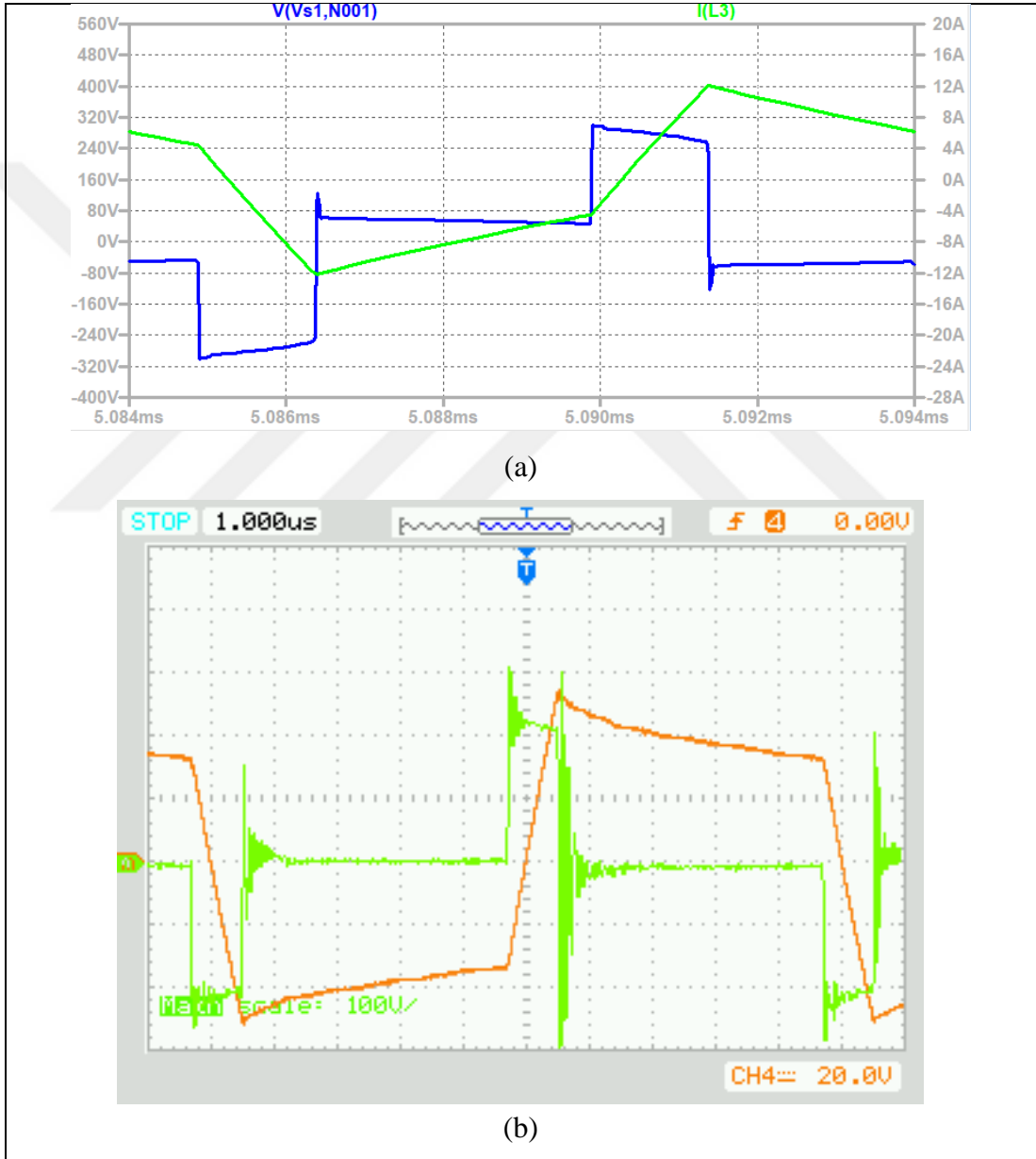
Şekil 4.1. DAB devresi SPS yönteminde iken kaçak endüktans üzerinde (a) benzetimdeki akım (yeşil) ve gerilim (mavi) (b) deneydeki akım (turuncu) ve gerilim (yeşil)
