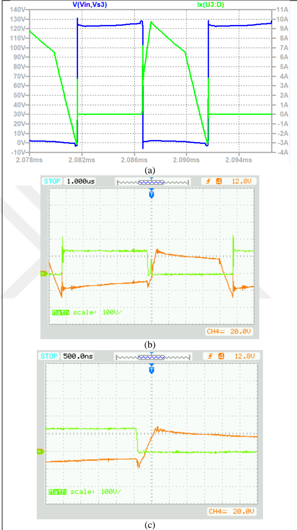
Şekil 4.13. DAB Devresi D_1 = 0.16, D_2 = 0, D_3 = 0.24 EPS yönteminde iken S2 anahtarının üzerinde (a) benzetimdeki akım (yeşil)-gerilim (mavi), (b) deneydeki akım (turuncu) ve gerilim (yeşil) ve (c) iletim anı
