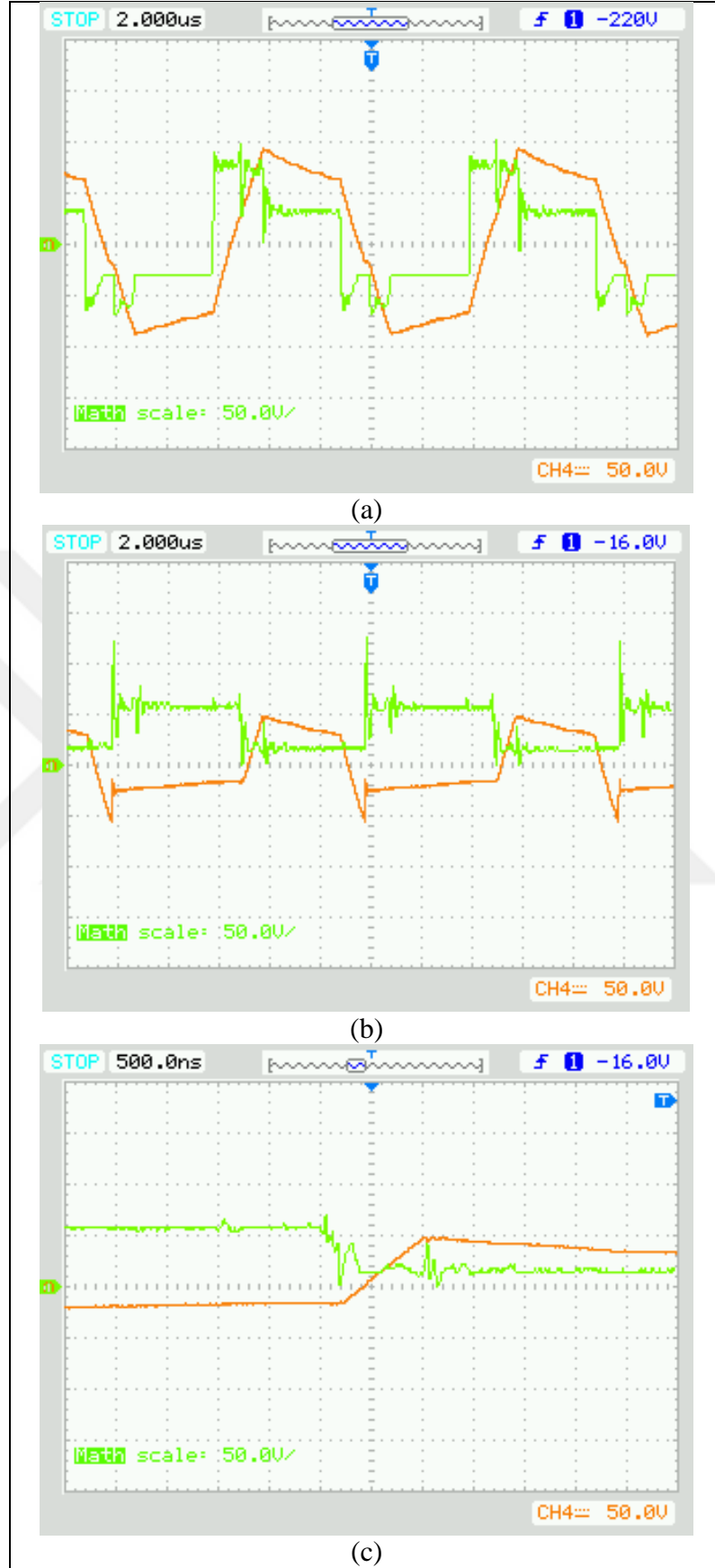
Şekil 4.20. DAB Devresi TPS yönteminde iken (a) kaçak endüktans üzerinde akım (yeşil)-gerilim (mavi) (b) MOSFET üzerinde akım (turuncu) ve gerilim (yeşil) ve (c) iletme geçme anı
