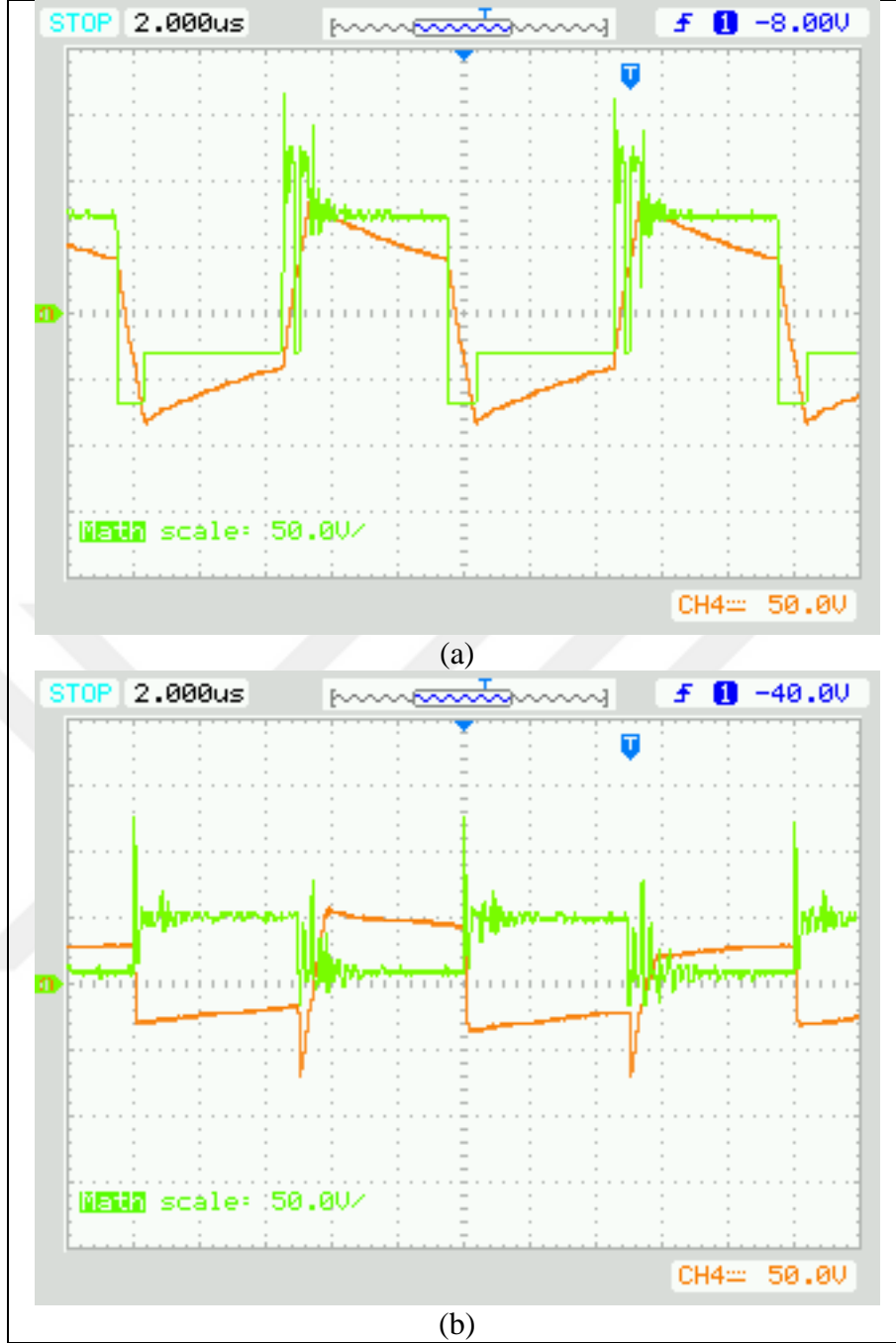
Şekil 4.18. DAB devresi SPS yöntemi ile çalışmasında (a) kaçak endüktans üzerinde oluşan akım (turuncu) gerilim (yeşil) ve (b) MOSFET üstünde oluşan akım (turuncu) gerilim (yeşil) şekilleri
