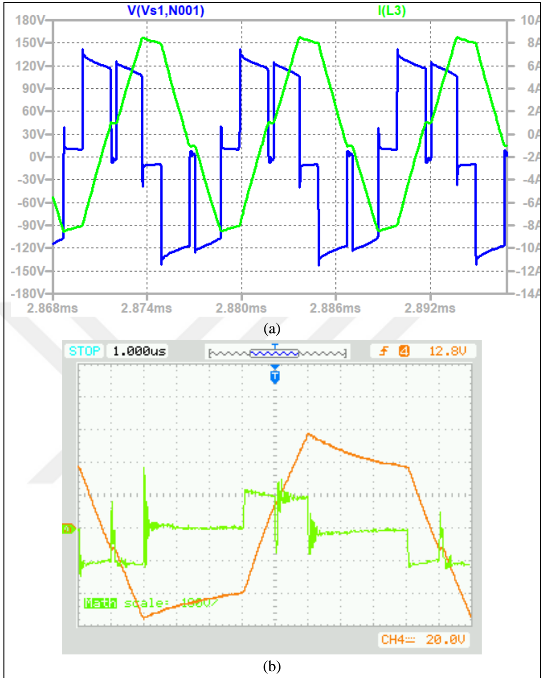
Şekil 4.4. DAB devresi TPS yönteminde iken kaçak endüktans üzerinde (a) benzetimdeki akım (yeşil)-gerilim (mavi) ve (b) deneydeki akım (turuncu) ve gerilim (yeşil)
