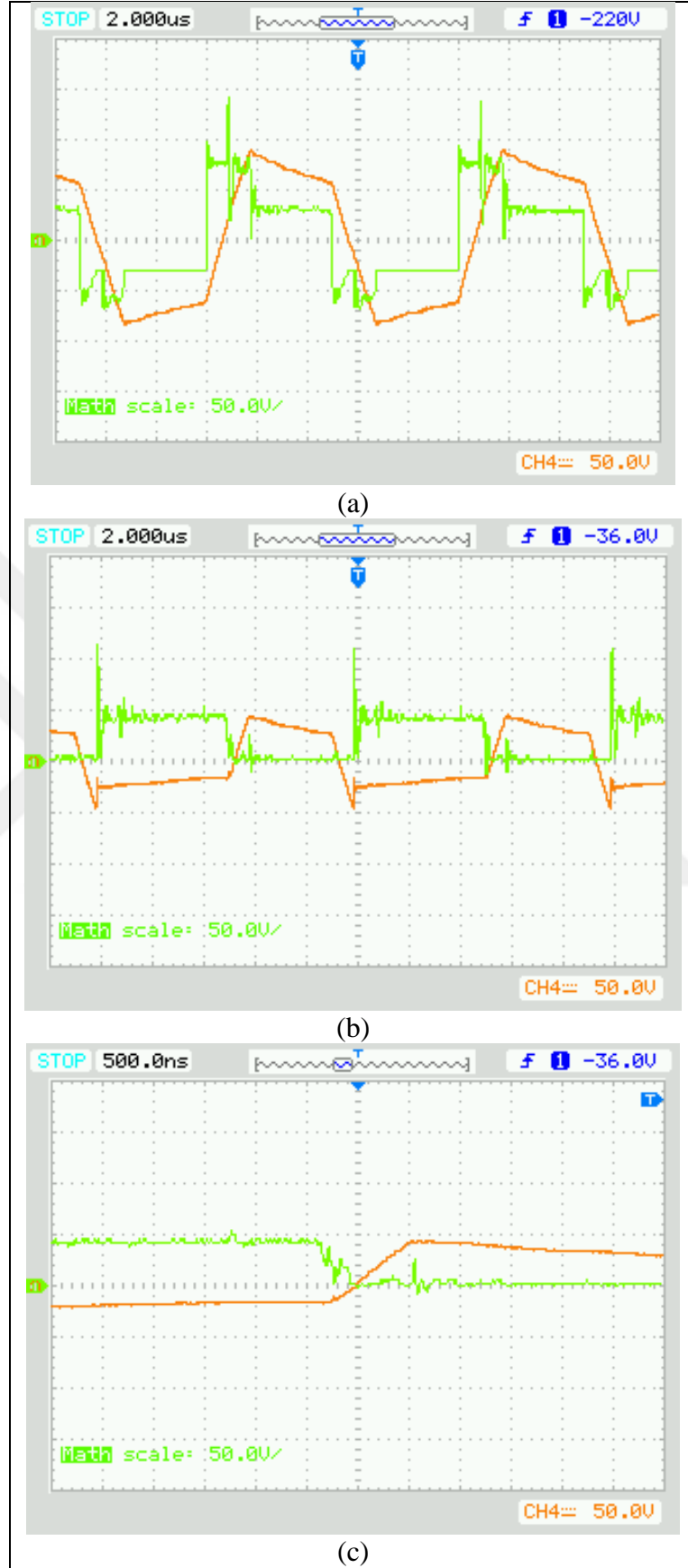
Şekil 4.22. DAB devresi D_1 = D_2 = D_3 = 0.17 DPS yönteminde iken (a) kaçak endüktans üzerindeki akım (yeşil)-gerilim (mavi) (b) MOSFET üzerindeki akım (turuncu) ve gerilim (yeşil) ve (c) iletme geçme anı
