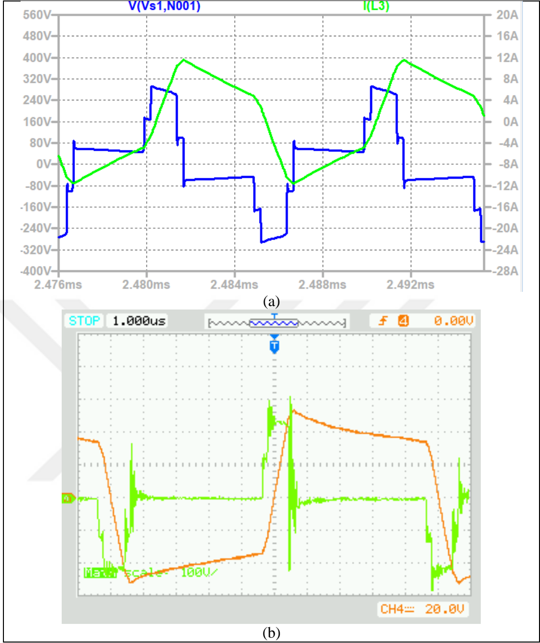
Şekil 4.15. DAB devresi D_1 = D_2 = 0.03, D_3 = 0.15 DPS yönteminde iken kaçak endüktans üzerinde (a) benzetimdeki akım (yeşil)-gerilim (mavi) ve (b) deneydeki akım (turuncu) ve gerilim (yeşil)
