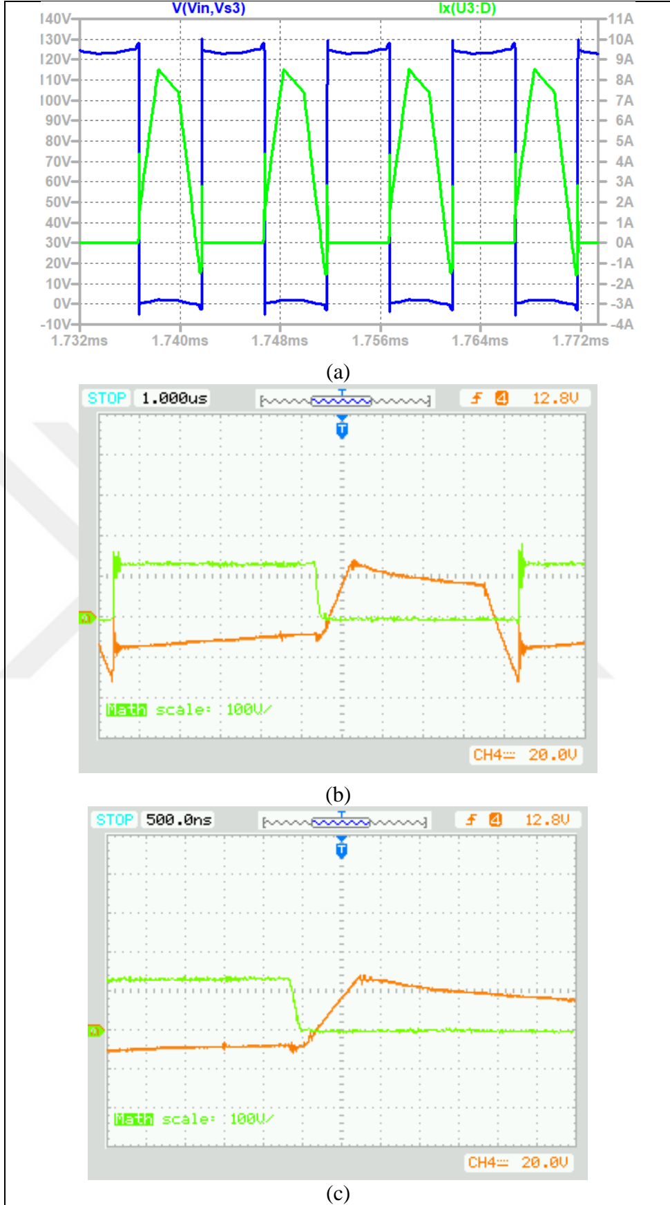
Şekil 4.10. DAB devresi D_1 = D_2 = D_3 = 0.17 DPS yönteminde iken S2 anahtarının üzerinde (a) benzetimdeki akım(yeşil)-gerilim(mavi), (b) deneydeki akım (turuncu) ve gerilim (yeşil) ve (c) iletim anı
