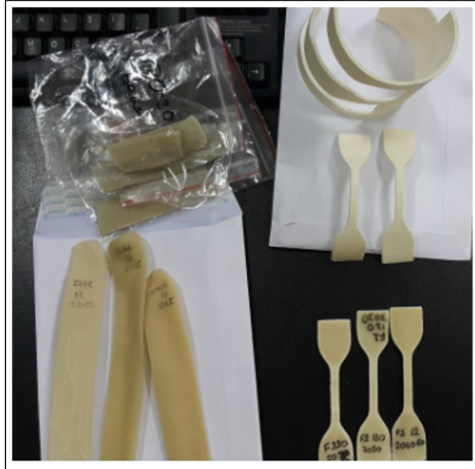
Şekil 3.12: Mekanik dayanım testi için hazırlanmış örnekler (ASTM D 638 standardı).
