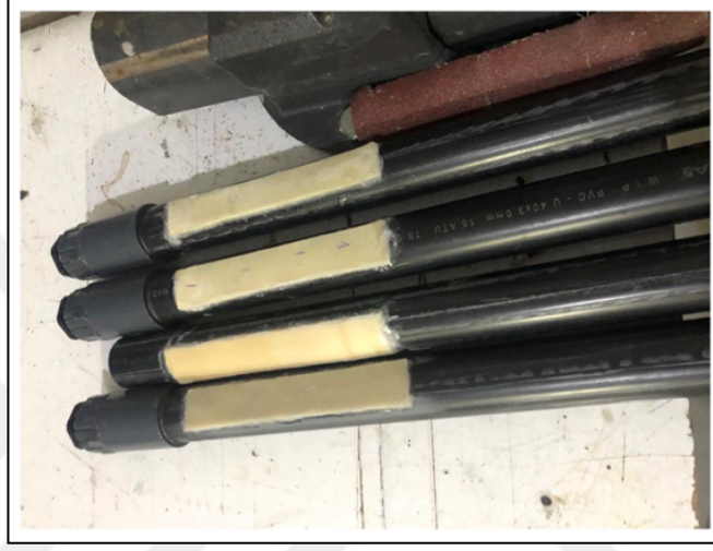
Şekil 3.7: Heterojen membranlar ile oluşturulan anot hücreleri.
