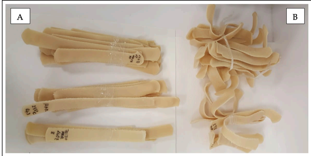
Şekil 4.21: A) Havada ve B) suda soğutma uygulanan membranlar.
