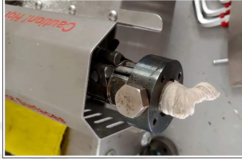
řekil 4.14: Yksek MFI deęerli PE2 ile ekstrzyon.
