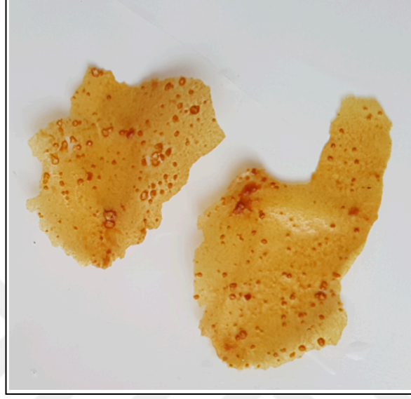
Şekil 4.11: Membran yapısındaki aglomere HNT nanopartikülleri.
