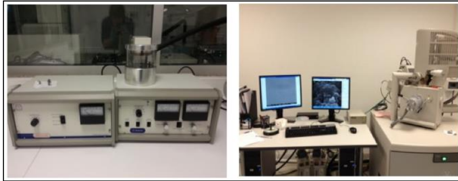
Şekil 3.17: SEM-EDX Cihazı ve kaplama ünitesi.
