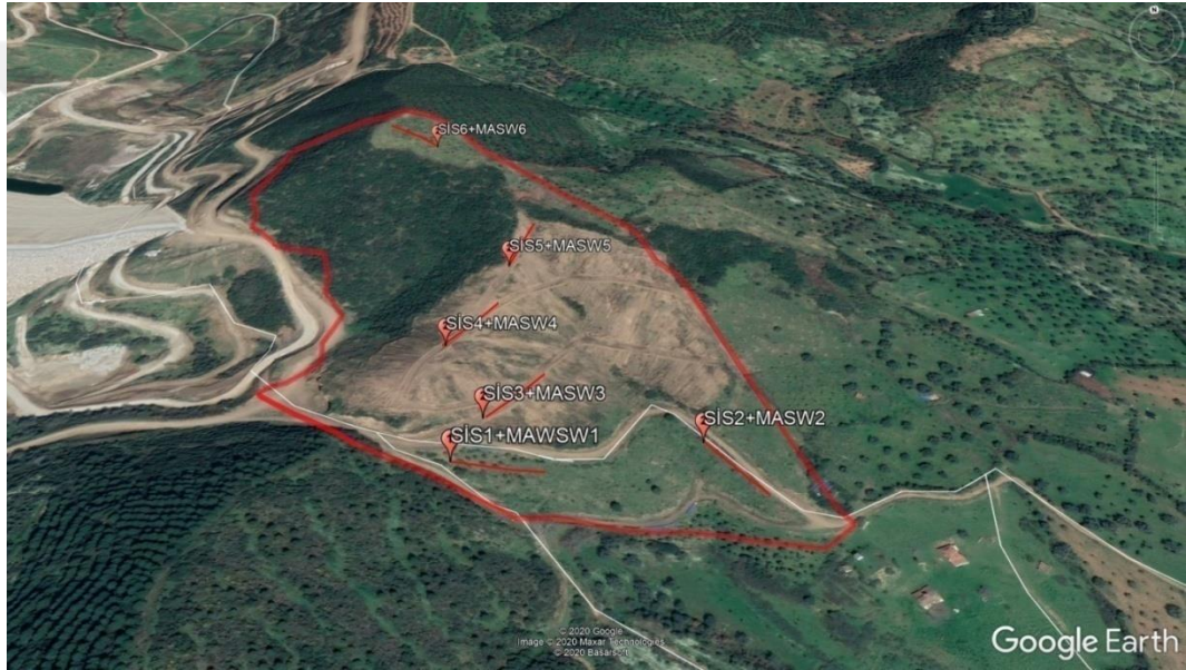
Şekil 4.9. İnceleme alanında alınan sismik ve masw ölçümüne ait koordinatların görünümü
