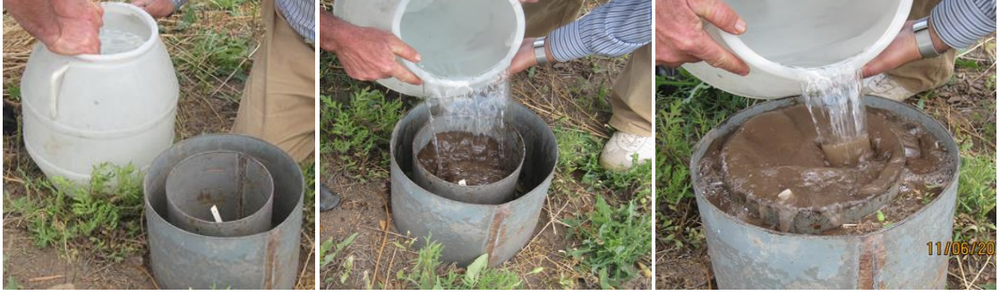
Şekil 3.9. Değişken seviyeli çift silindirli infiltrometre ile deneme alanında infiltrasyon ölçümleri
