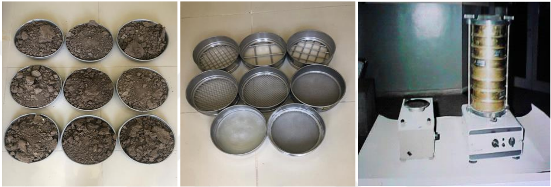
Şekil 3.11. Parçacık boyut dağılımını belirlemede kullanılan toprak örnekleri elekler, mekanik sarsıcı ve hassas terazi
