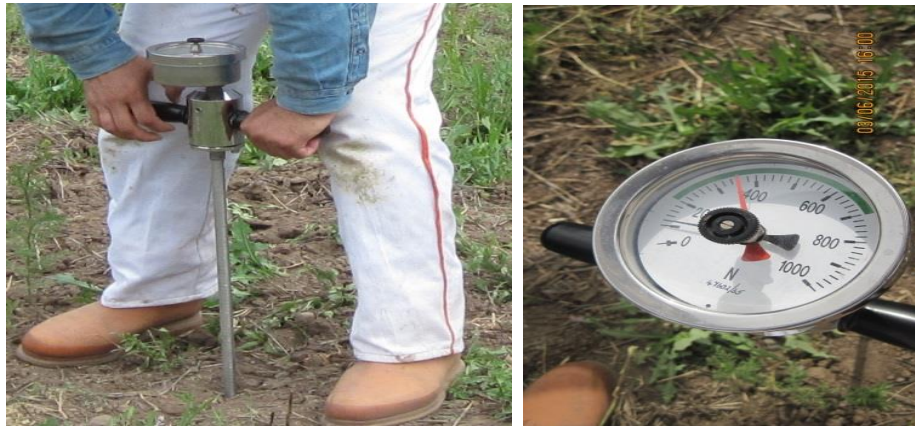
Şekil 3.10. Deneme alanında penetrometre ölçümleri
