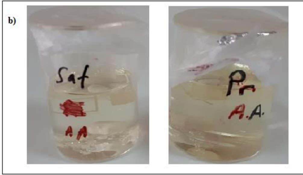
4.2. a) Sentez anında saf ve \text{Pr}^{+3} katkılı \text{TiO}_2 çözeltiler, b) 24 saat beklettikten sonra saf ve \text{Pr}^{+3} katkılı \text{TiO}_2 çözeltiler
