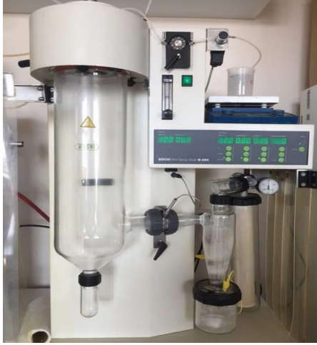
Şekil 3.2. Püskürterek kurutma ünitesi (Büchi Mini Spray Dryer B-290)
