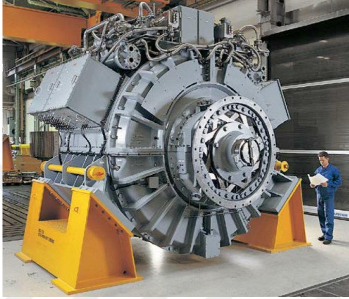
Şekil 2.7 : Reis sınıfı denizaltılarda kullanılan SINAVY PERMASYN FTDA motoru [17].
