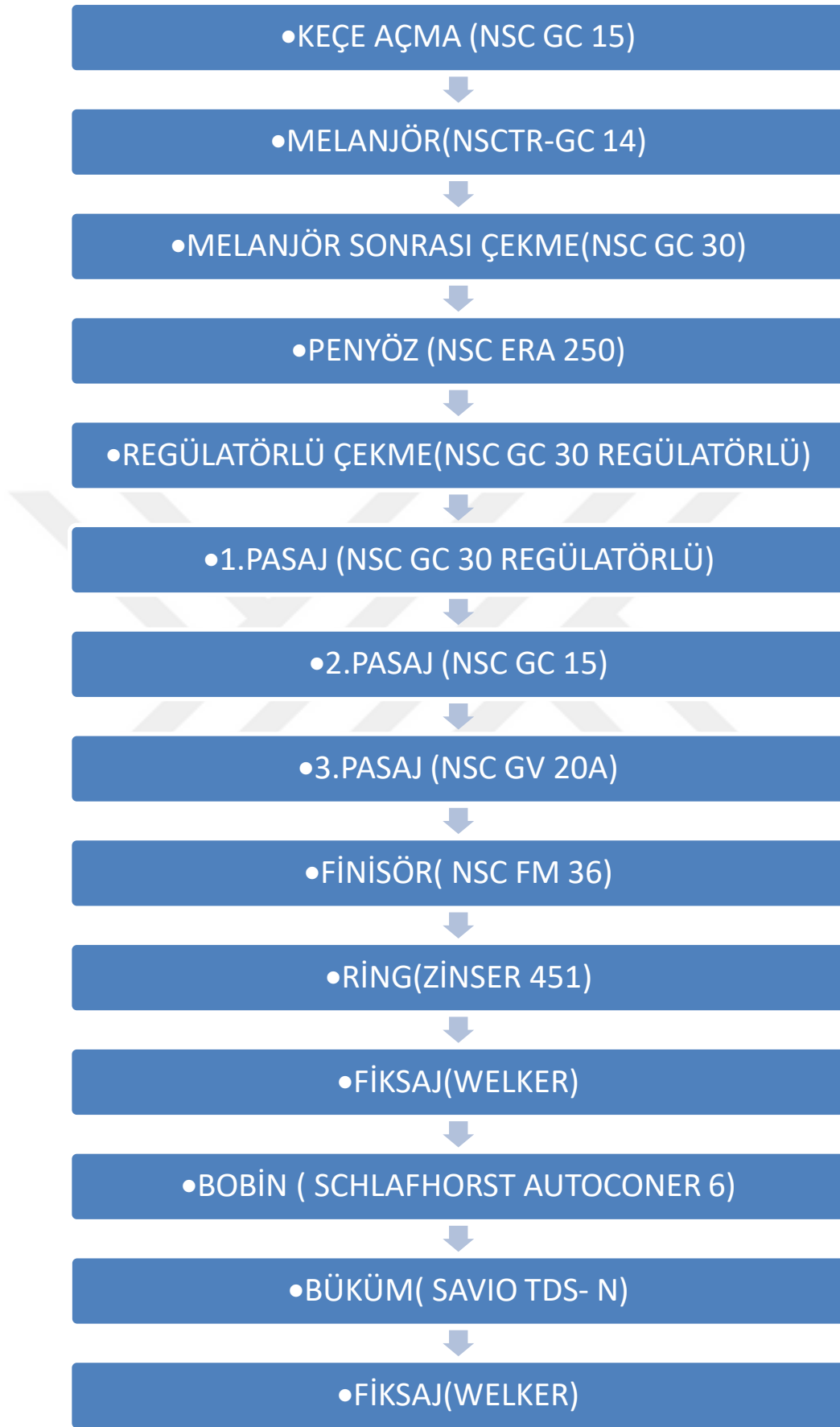
Şekil 4. 1. Çalışma kapsamında üretilen ipliklere ait iplik üretim hattı
