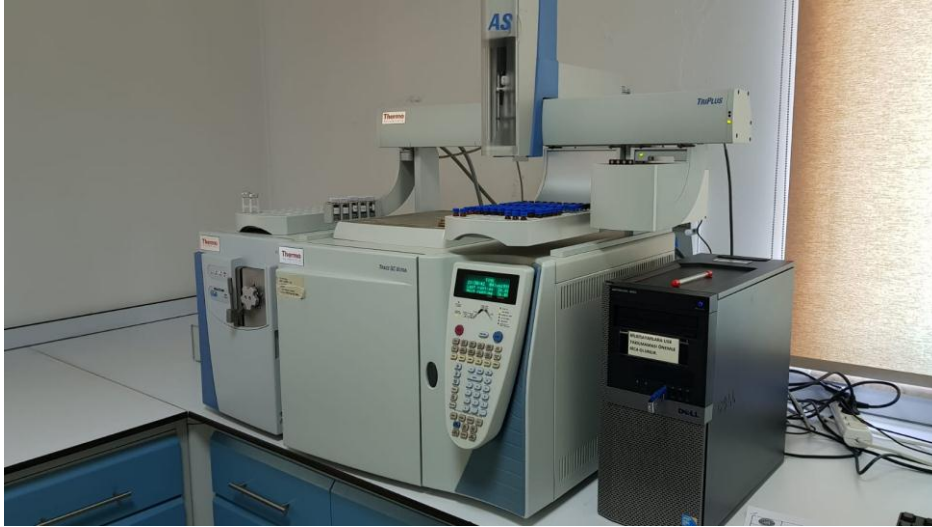
Şekil 3.7. Naftalin analizinin yapıldığı GC-MSD cihazı (Thermo Trace GC Ultra ISQ)
