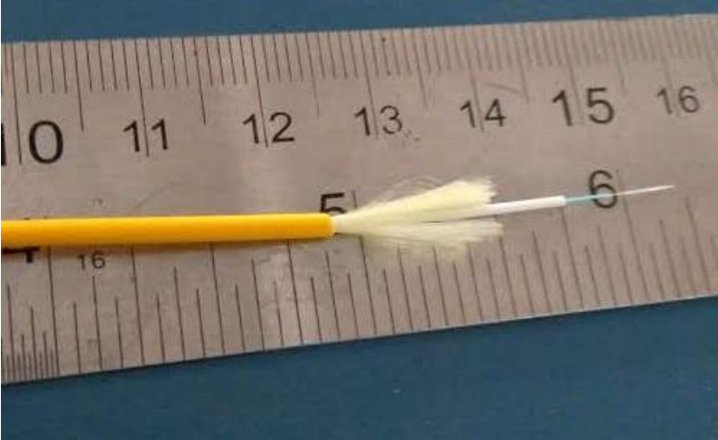
Şekil 4.37. Yerli üretim 2 mm tek fiberli drop kablo
