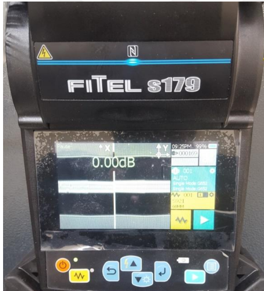
Şekil 3.20. Ek işleminin gerçekleştirilmesi ve kayıp değeri
