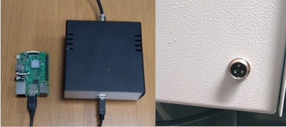
Şekil 3.4. raspberry pi 3, arduino ve lojik çıkış portu
