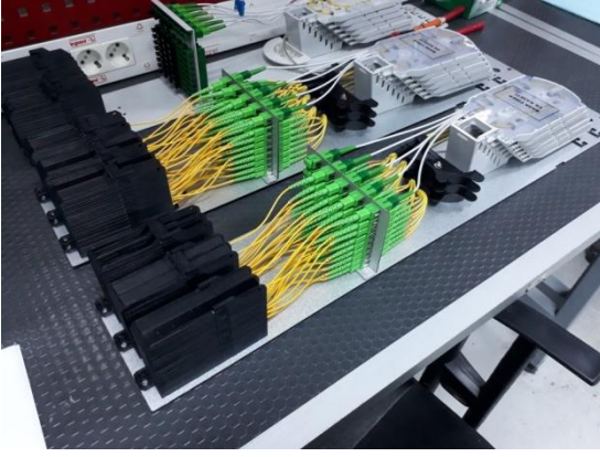
Şekil 3.23. Optik splitter ve bağlantı elemanlarının kullanımı
