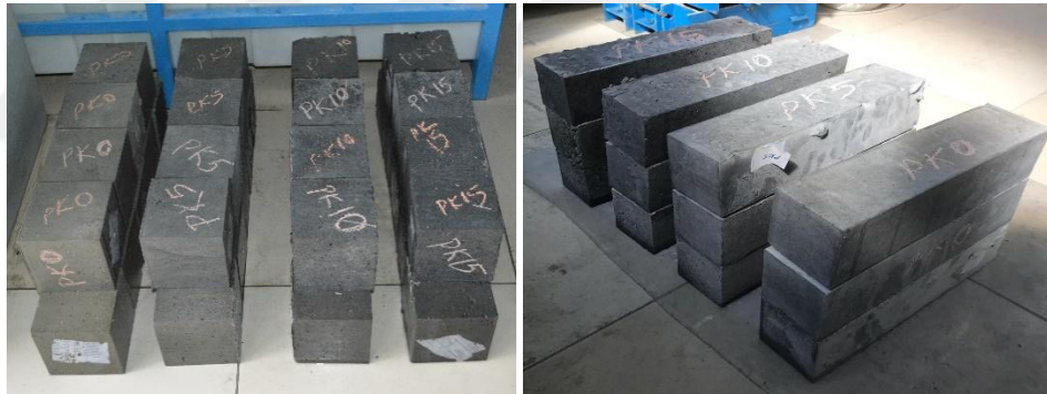
Şekil 3.9. Küp ve kiriş numuneler
