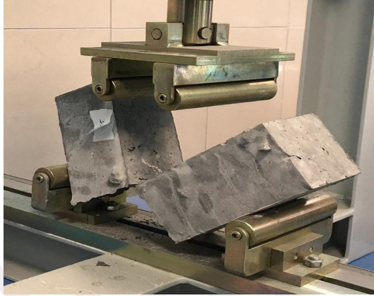
Şekil 3.13. Eğilme dayanımı deneyi
