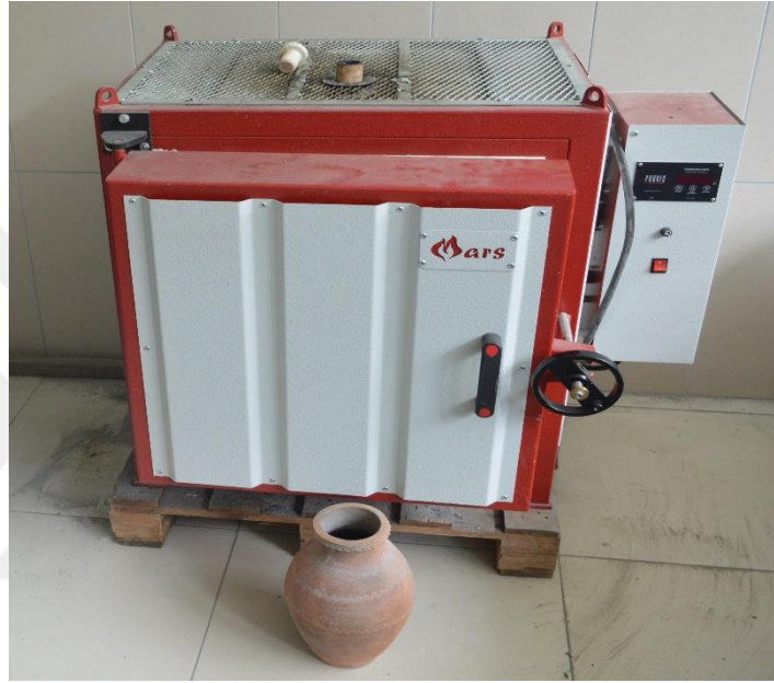
Şekil 3.2. Pirinç kabuğu yakma işlemi için kullanılan fırın
