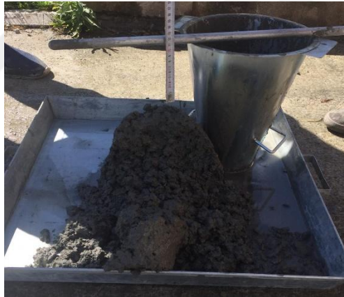
Şekil 3.10. Taze betonda çökme deneyi
