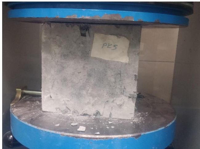
Şekil 3.14. Basınç dayanımı deneyi
