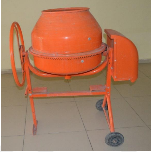
Şekil 3.5. (a) Betonyer (b) Kalıplar
