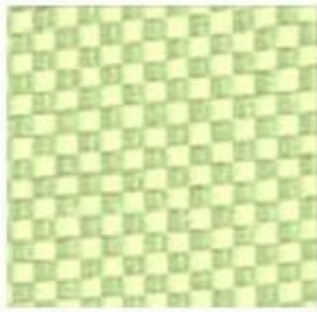
Şekil 2.5. Hasır biçiminde örülmüş cam elyaf tabakası (Ekici 2009).
