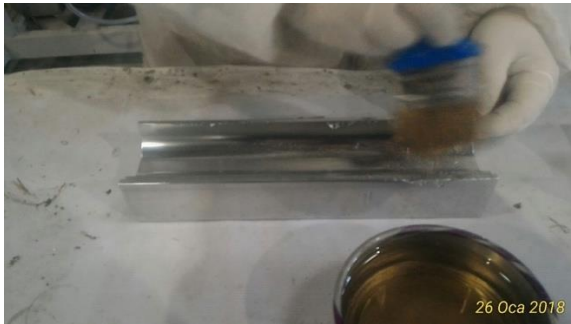
Şekil 3.5. İlk kat epoksi uygulama işlemi
