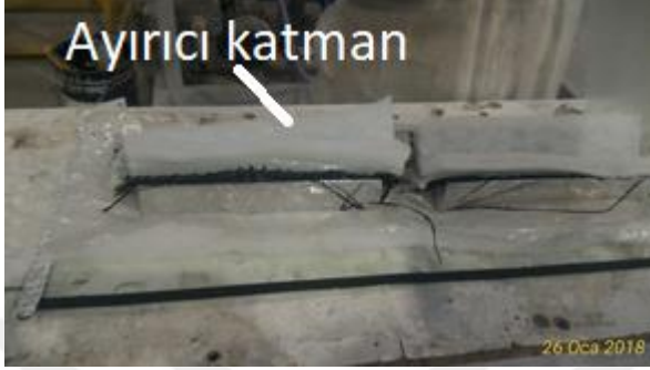
Şekil 3.6. Kalıplara karbon elyaf ve ayırıcı yerleşim işlemi
