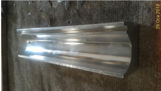
Şekil 3.4. Üzeri vakum filmi kaplanıp kurumaya bırakılan kalıp
