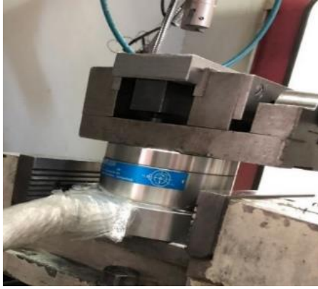
Resim 4.6. İş parçasının dinamometreye bağlanma tipi
