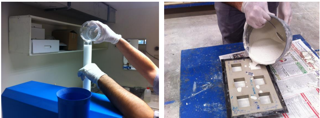
Şekil 3.17. Beton karışımı ve numune döküm işlemi.
