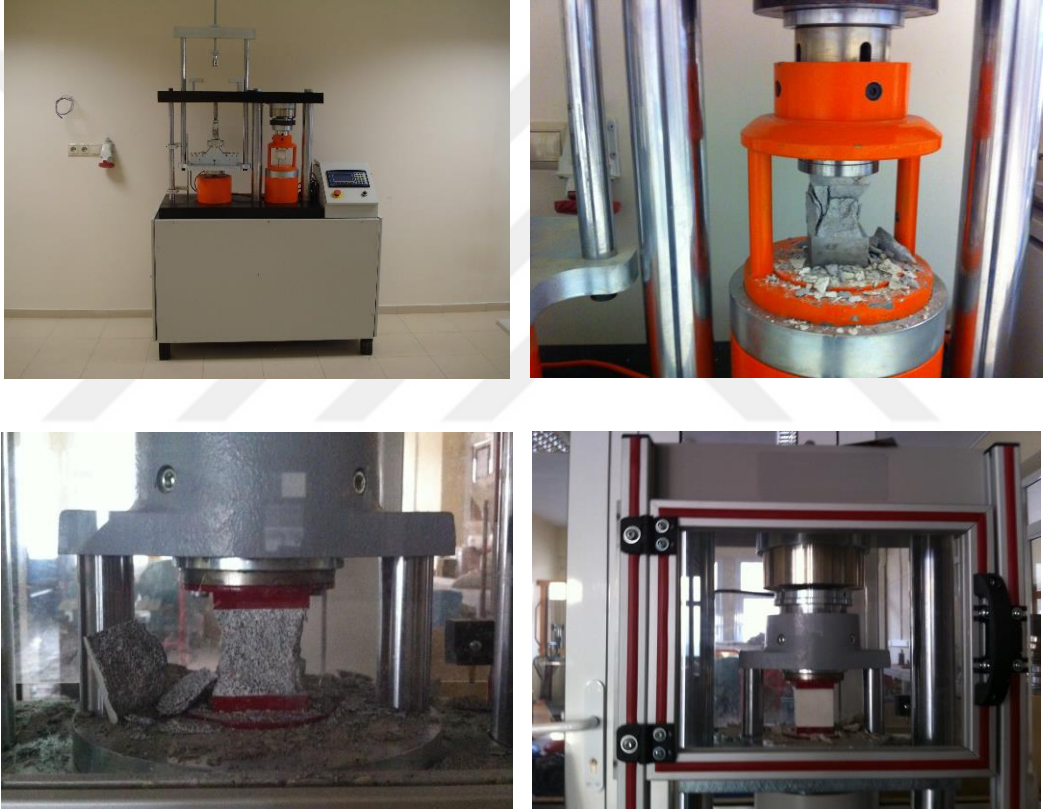
Şekil 3.15. Basınç dayanımı ölçüm test cihazı ve deney yapılışına ait görseller.
