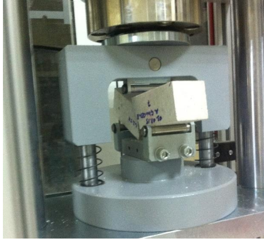
Şekil 3.16. Eğilme dayanımı ölçüm test cihazı ve deney yapılışına ait görsel.
