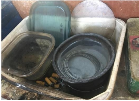
Resim 4.65. Örne cebenin sülfür asitte beklenmesi
