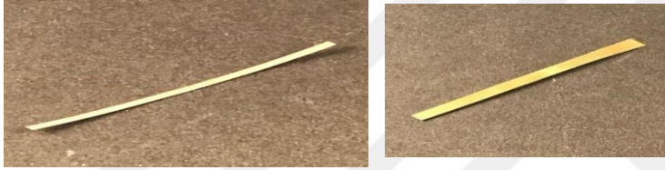
Resim 4.39. 925 ayar gümüş kaynak, 14 ayar altın kaynak
