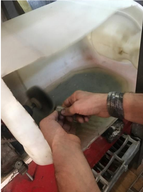
Resim 4.68. Gümüş telin fırça motoruyla temizlenmesi ve parlattırılması
