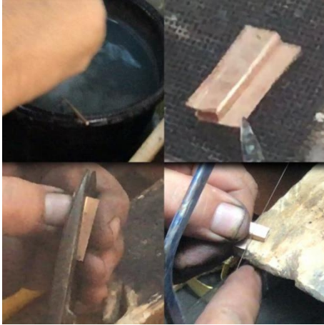
Resim 4.103. Kaynatılan ve birleşen parçaların küçük parçalara bölünmesi
