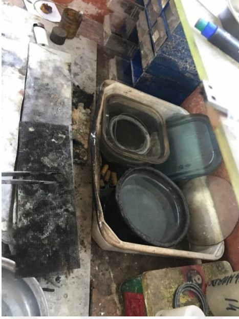
Resim 4.67. Tel gümüşün asitten çıkartıldıktan sonra suda durulanması
