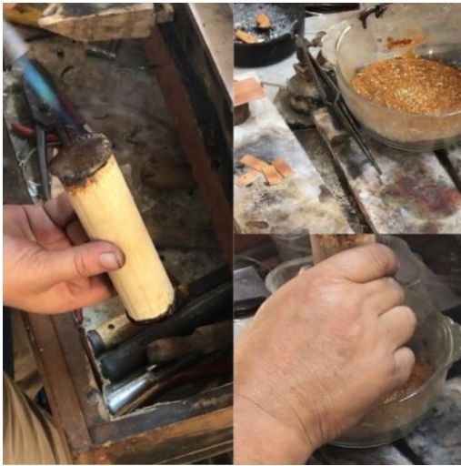
Resim 4.99. Tahta rokalayı ısıtıp ve gomalağa batırılması
