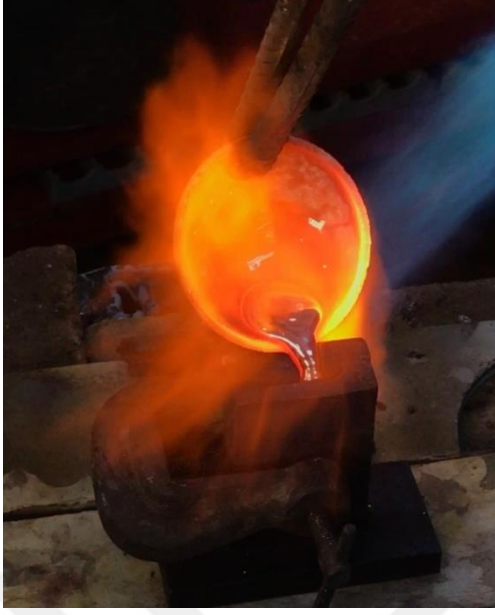
Resim 4.81. Eritilen gümüşün kalıp içine dökülmesi
