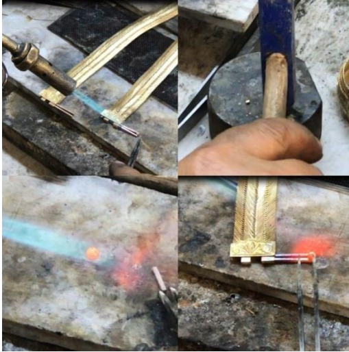
Resim 4.111. Anahtar topunun hazırlanması ve kaynatılması
