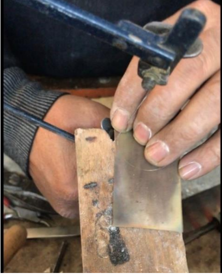
Resim 4.90. Testere yardımıyla desenin çıkarılması
