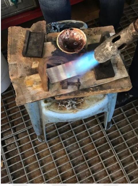
Resim 4.87. Plaka gümüşün tavlama işlemi
