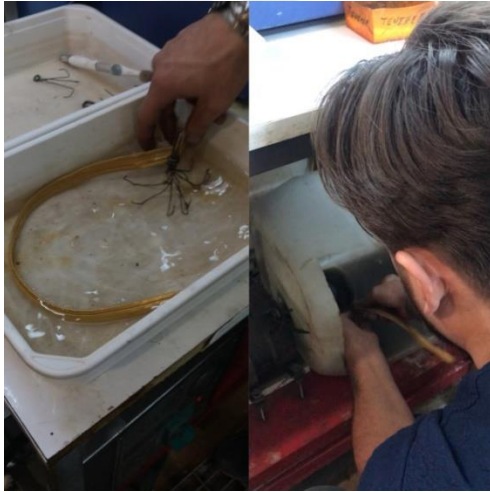
Resim 4.76. Cebe örgüsünün suda durulanması ve fırça motorunda temizlenmesi
