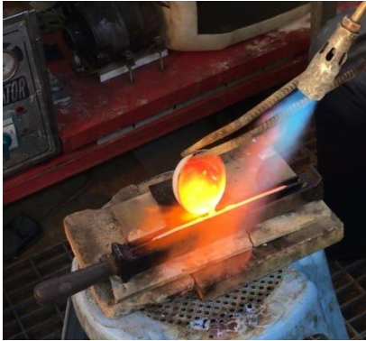
Resim 4.4. Eritilen gümüşün astar derece içine dökülmesi
