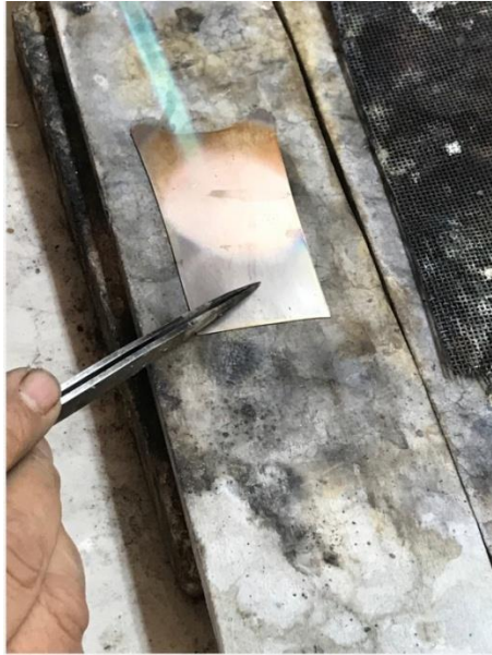
Resim 4.88. Plaka gümüşün pensiyle düzeltilmesi
