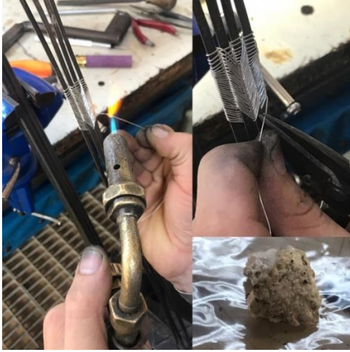
Resim 4.74. Cebe örmesinde tel kaynatması
