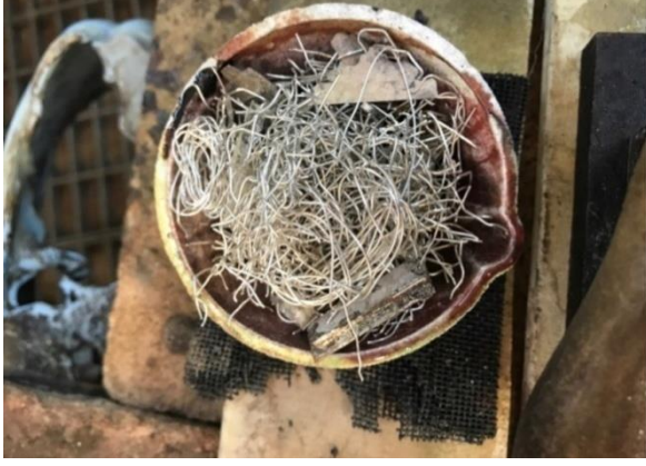
Resim 4.2. Seramik pota içinde hurda gümüş
