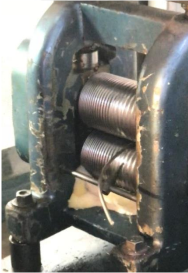
Resim 4.57. Tel silindir makinesinde inceltip ve uzatılan tel
