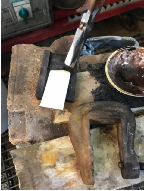
Resim 4.82. Kalıbın içinden çıkarılan gümüş plaka
