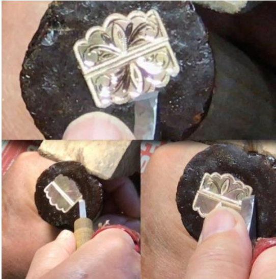
Resim 4.101. Kalem işçiliğiyle kazma tekniği
