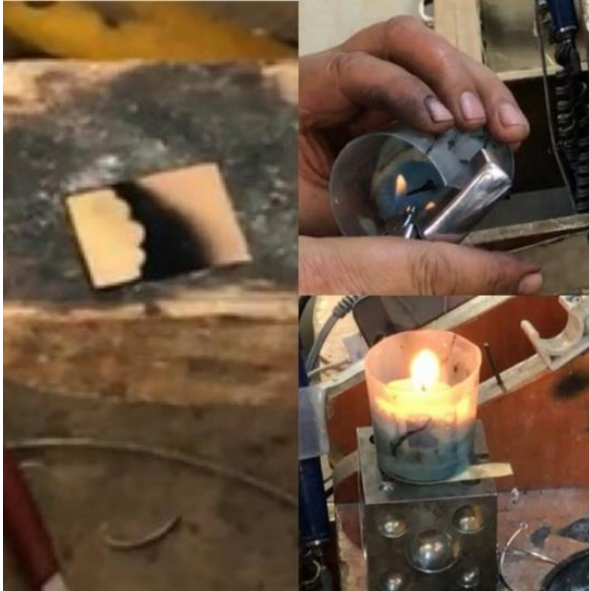
Resim 4.97. Mum isiyile altın plakanın üzerinde desen aktarma
