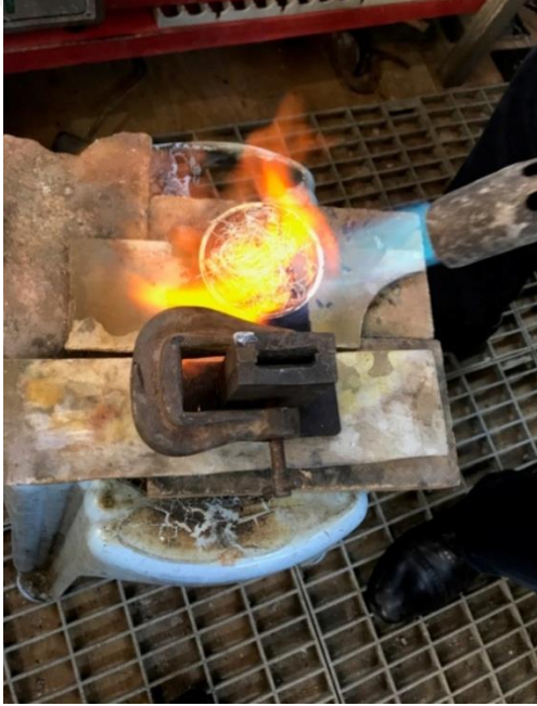
Resim 4.80. Teneker dökerek, seramik pota içinde eritilen hurda gümüşler
