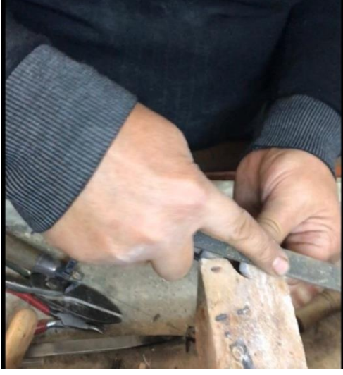
Resim 4.91. Eęe ile pürüzsüzlerin temizlenmesi
