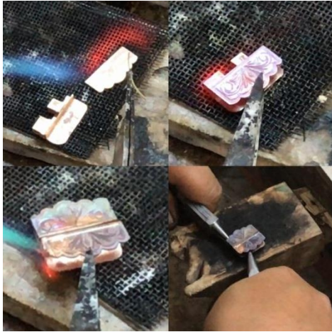
Resim 4.105. Süs kilit ve kilidin kaynatılarak birleşmesi
