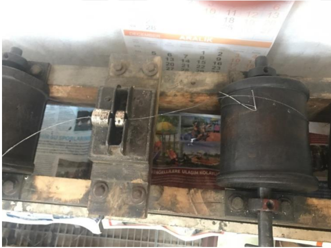
Resim 4.61. Çıkırıla ve haddeyle tel incelme aşaması
