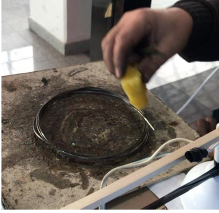
Resim 4.58. Telin bal mumuyla yağlanması
