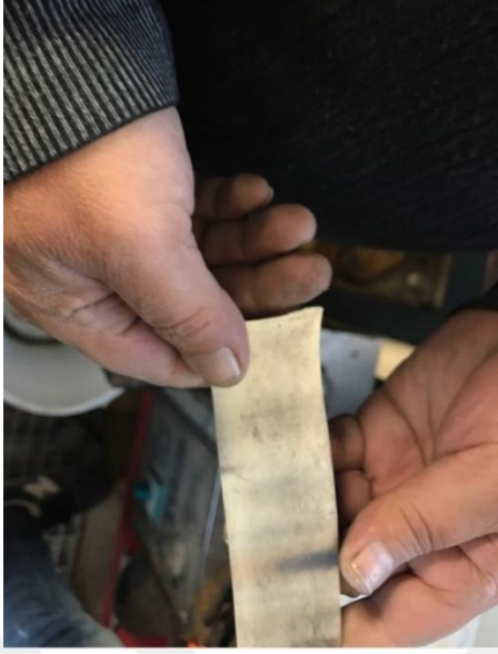
Resim 4.85. Astar silindir makinesinde işlem görülmüş plaka gümüş
