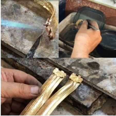
Resim 4.109. Tavlama işlemi ve asitte beklenmesi
