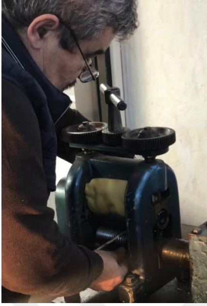
Resim 4.56. Sudan çıkarılan gümüşün tel silindir makinesinden geçirilmesi
