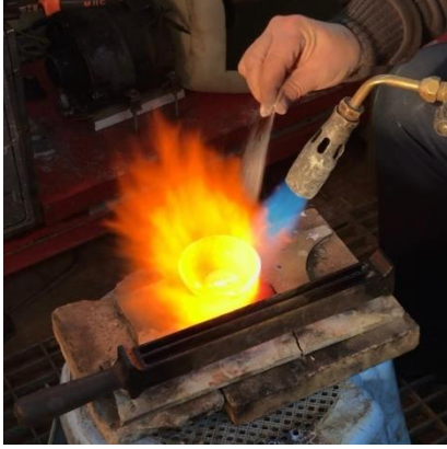
Resim 4.3. Hurda gümüşlerin teneker dökerek eritilmesi
