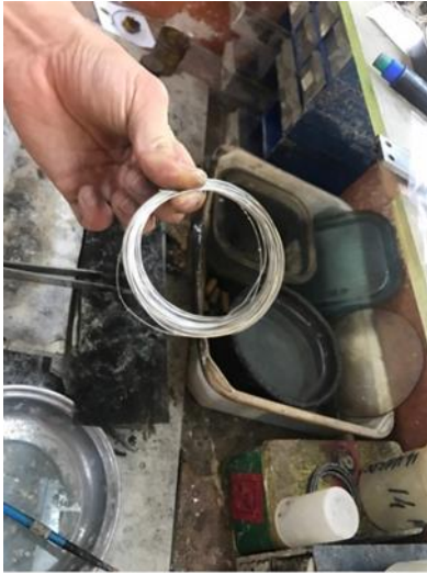
Resim 4.66. Tel gümüşün asitten çıktıktan sonraki hali
