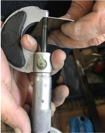
Resim 4.86. Plaka gümüşün inceliğinin ölçmesi
