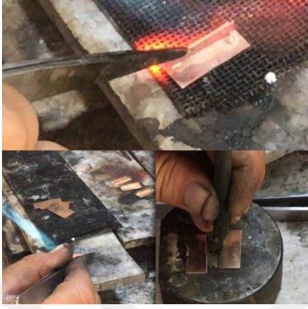
Resim 4.102. Kaynatarak parçaların birleşmesi
