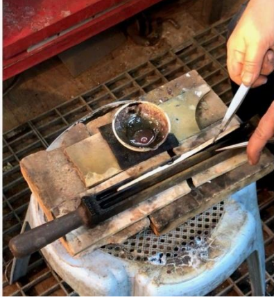
Resim 4.5. Eritilmiş gümüşün kalıptan çıkarılması
