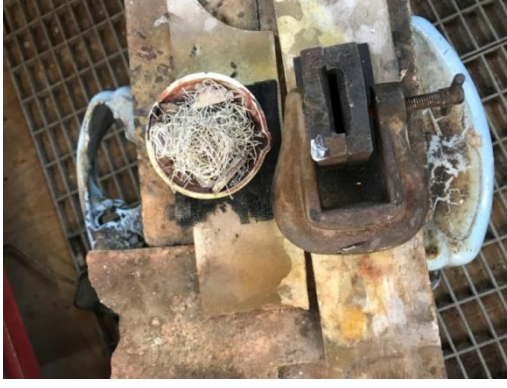
Resim 4.79. Seramik pota içinde hurda gümüş veastar derece (kalıp)
