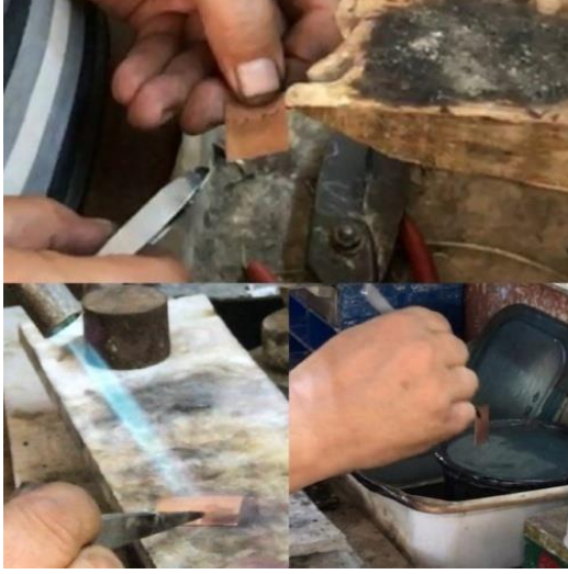
Resim 4.96. Kesilen plakanın düzleşmesi ve beyazlaması
