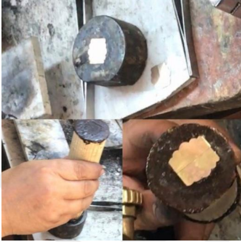
Resim 4.100. Altın süs plaka kilidimizi tahta rokalanın üzerine aktarılması
