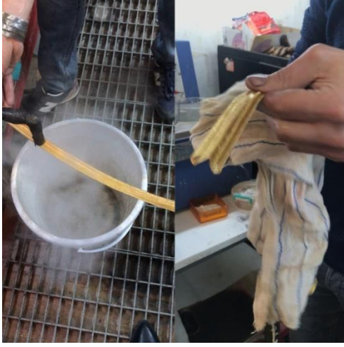
Resim 4.77. Örne cebenin buhar makinesinde parlaması ve bezle kurulanması
