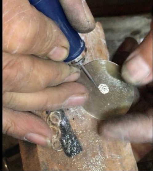
Resim 4.92. Gravür aletiyle, noktaların koyulması (Nokta teknięi)
