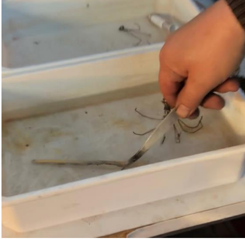
Resim 4.6. Kalıptan çıkarılan gümüşün soğuması için suda bekletilmesi
