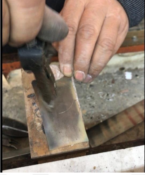
Resim 4.89. Gümüş plakaya pergel çizgi atılması
