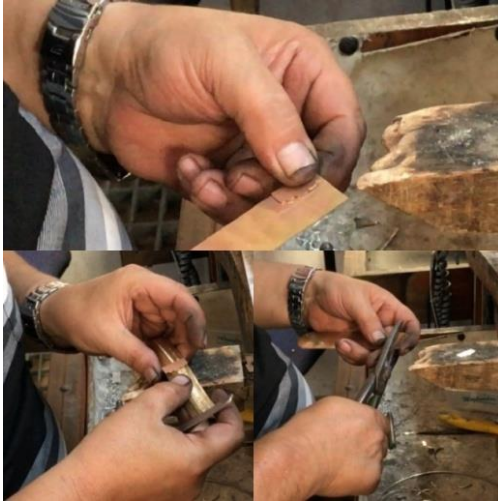
Resim 4.95. Altın plakanın süs kilit yapımı plakanın ölçüsü ve kesilmesi
