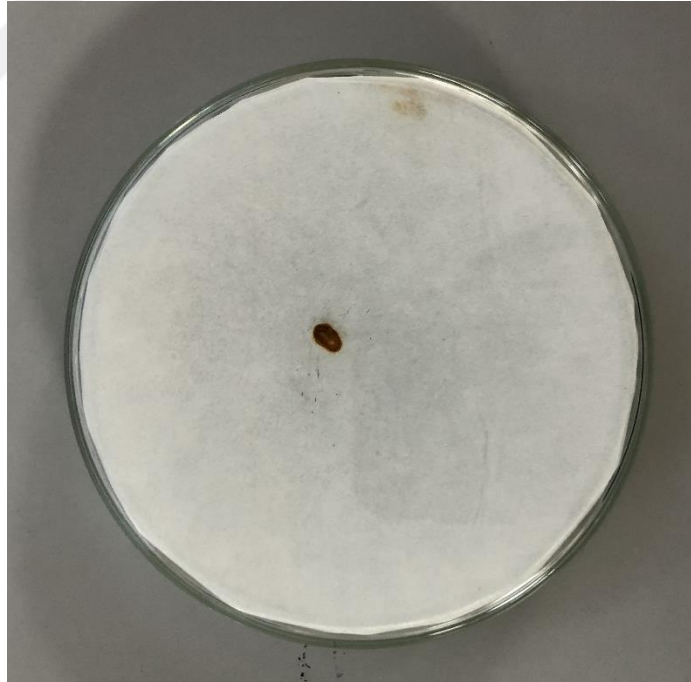
Şekil 3.7. L-Arjinin inhibitörlü metal işleme sıvısının %2,5 emülsiyon talaşlı korozyon pas testi sonucu
