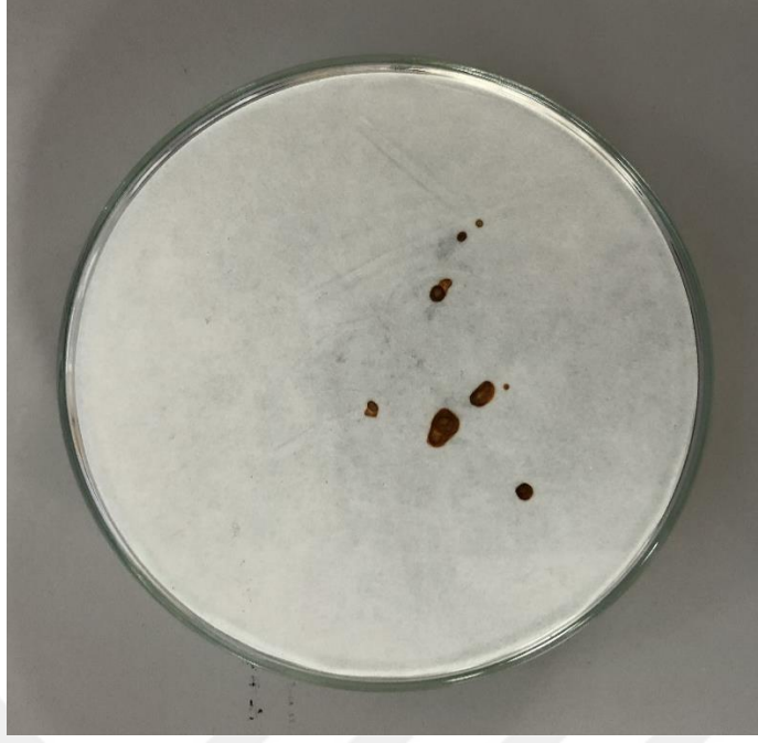
Şekil 3.6. TTZ inhibitörlü metal işleme sıvısının %2,5 emülsiyon talaşlı korozyon pas testi sonucu
