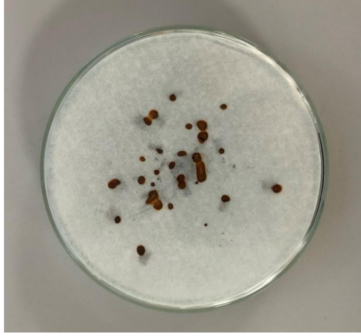
Şekil 2.5. Korozyon talaşı testi.
