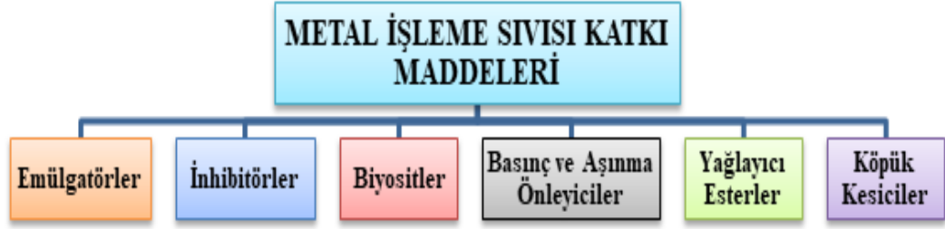
Şekil 1.10. Metal işleme sıvısına katılan katkı maddeleri.
