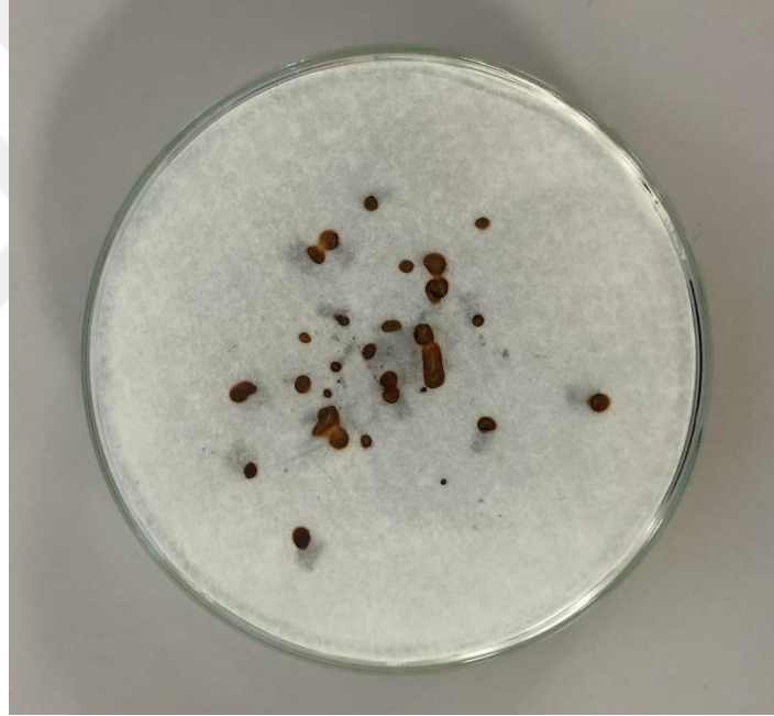
Şekil 3.5. Korozyon inhibitösüz metal işleme sıvısının %2,5 emülsiyon talaşlı korozyon pas testi sonucu
