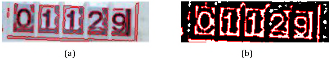
Şekil 3.17. Değil (NOT) İşlemi, (a) Uygulanmamış Görüntü, (b) Uygulanmış Görüntü
