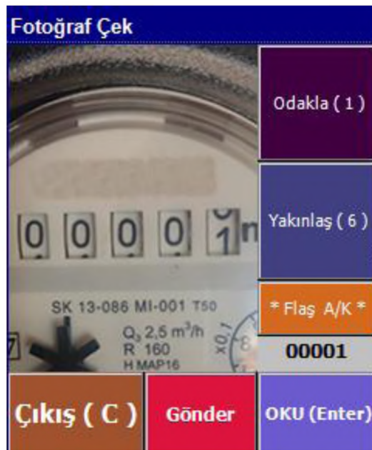
řekil 3.7. Casio IT-9000 El Terminali Saya Okuyucu Programının Ekran Grnts
