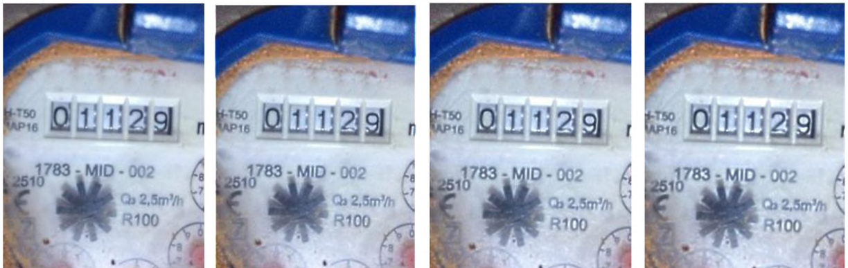
Şekil 3.10. Ortanca Filtre (a) 3x3 Matrisli, (b) 5x5 Matrisli, (c) 7x7 Matrisli, (d) 9x9 Matrisli
