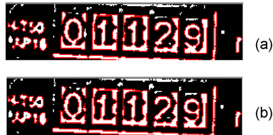
Şekil 3.20. Gauss Filtresi Uygulanmış Görüntü (a) 3x3, (b) 5x5
