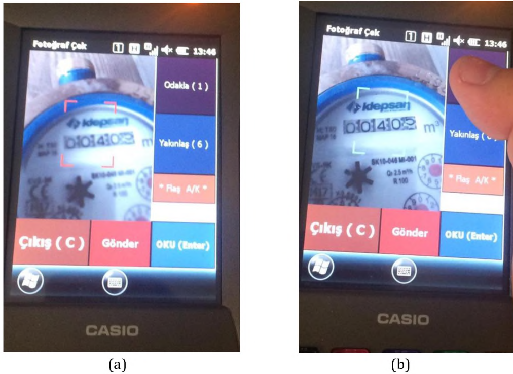
řekil 4.5. Casio IT-9000 zerinde Anlık Grnt (a) Odaklanamamıř, (b) Odaklanmış
