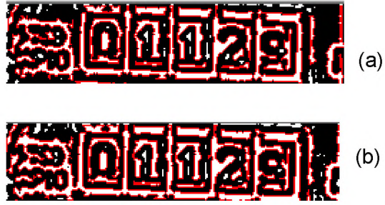
Şekil 3.23. Deđil (Not) İşlemli Filtreler (a) Sobel 3x3, (b) Prewitt 3x3
