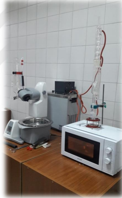
Şekil 3.2. Mikrodalga fırına modifiye edilmiş Soxhlet cihazı
