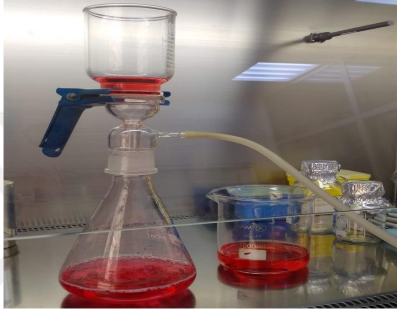
Şekil 2.1: DMEM-F12 süzme ile sterilizasyonu
