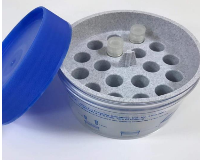
Şekil 3.9: Mr. Frosty içerisinde hücrelerin dondurulması
