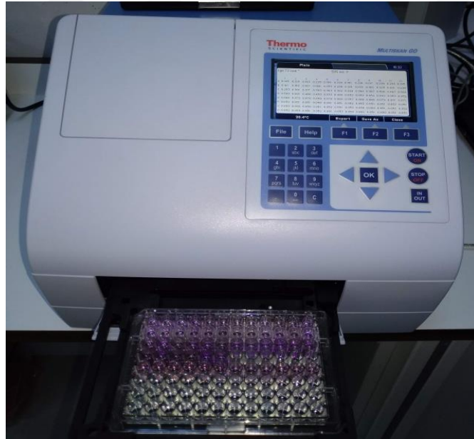
Şekil 3.16: ELISA cihazında renkleri değişen hücrelerin okutulması
