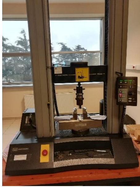
Şekil 3.12: Eğme çeneleri takılmış universal test cihazı.
