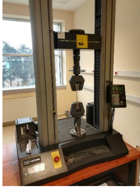
Şekil 3.11: Çekme çeneleri takılmış universal test cihazı.
