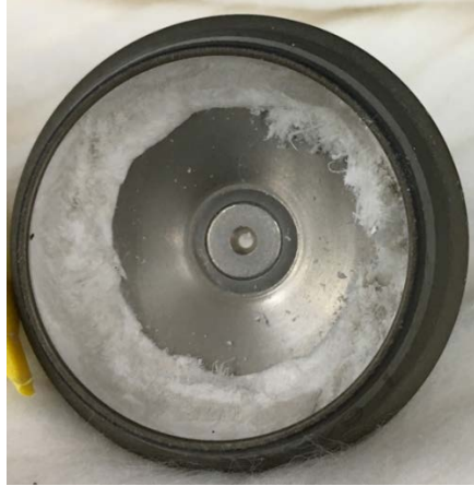
Şekil 4.11. Rotor içi lif sıvanması görüntüsü
