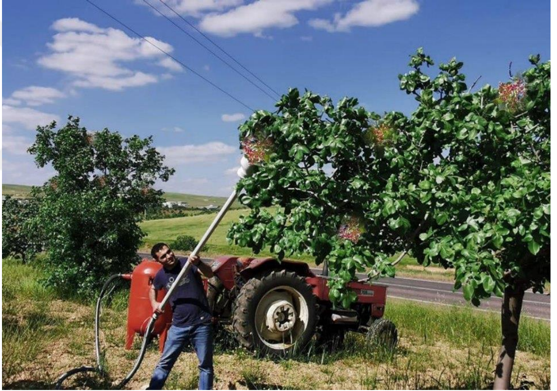
Şekil 4.1 Vakumlu antepfıstığı makinesi ile hasat işlemi
