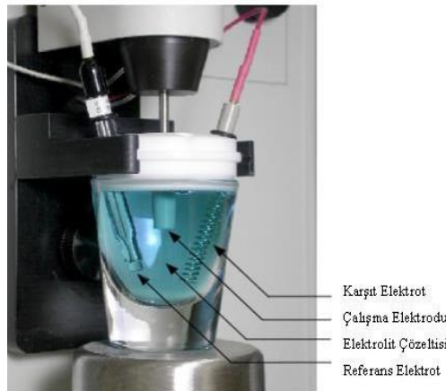
Şekil 3.9. Üç elektrotlu elektrokimyasal hücre.
