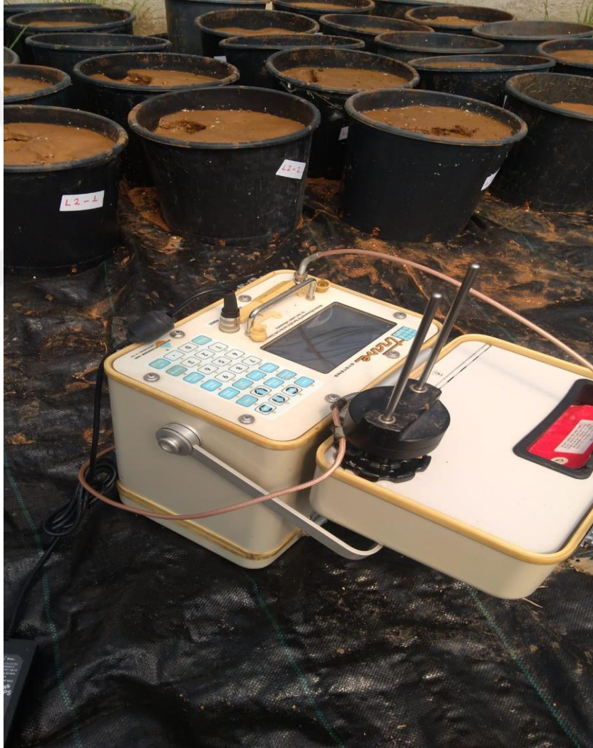
Şekil 3.5. TDR ile mevcut su içeriği belirlenmesi
