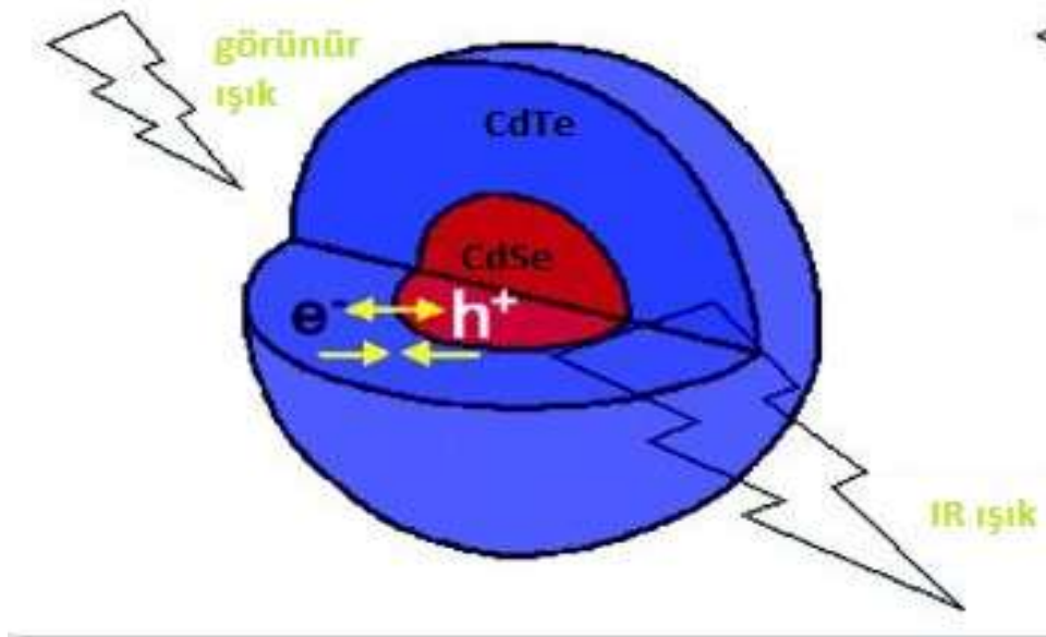
Şekil 4. Tip-II kuantum noktaların şematik gösterimi ve elektron/hole (e-/h+) konumları [19].
