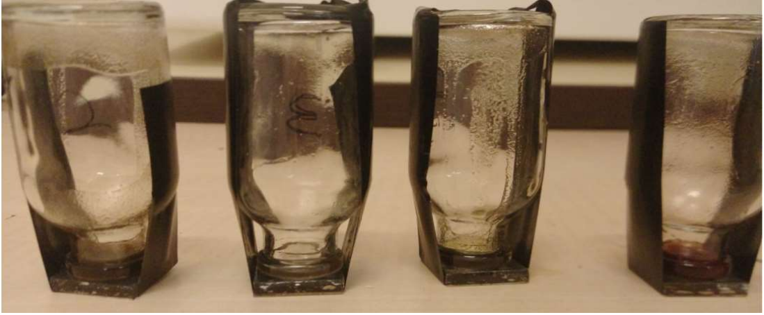
Şekil 19. FTO/TiO 2 /CdSe/CdTe oluşumu (her bir küçük cam tüpte farklı boyutlu kuantum noktalar mevcuttur).
