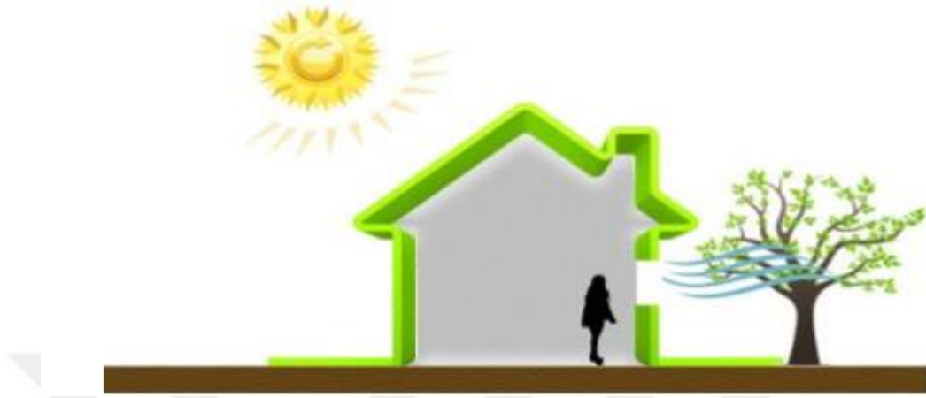
Şekil 2.4. Sıcak-kuru iklim bölgesinde batı yönünden kapalı mimari örneği [37].
