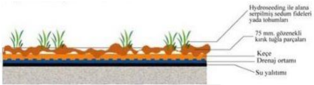
Şekil 2.24. Hydroseeding bitkilendirmesi detayı[69].
