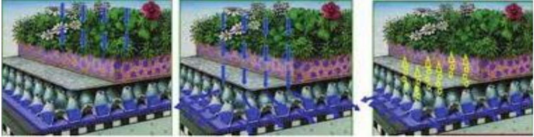
Şekil 2.13. Yeşil çatı sistemlerinin işleyiş şeması [63].
