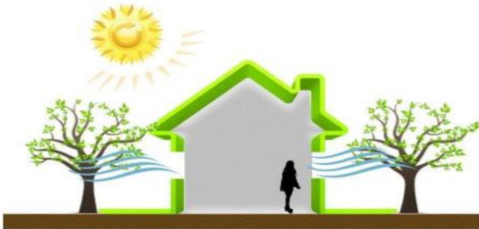
Şekil 2.5. Sıcak-nemli iklim bölgesi için rüzgar yönü ve peyzaj tasarımı [37].
