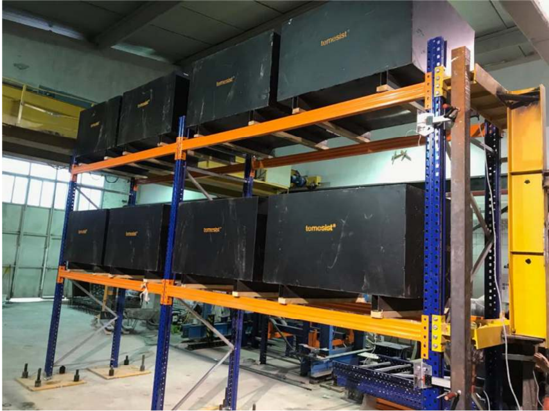
Şekil 4.1. Çaprazsız model genel görünüm
