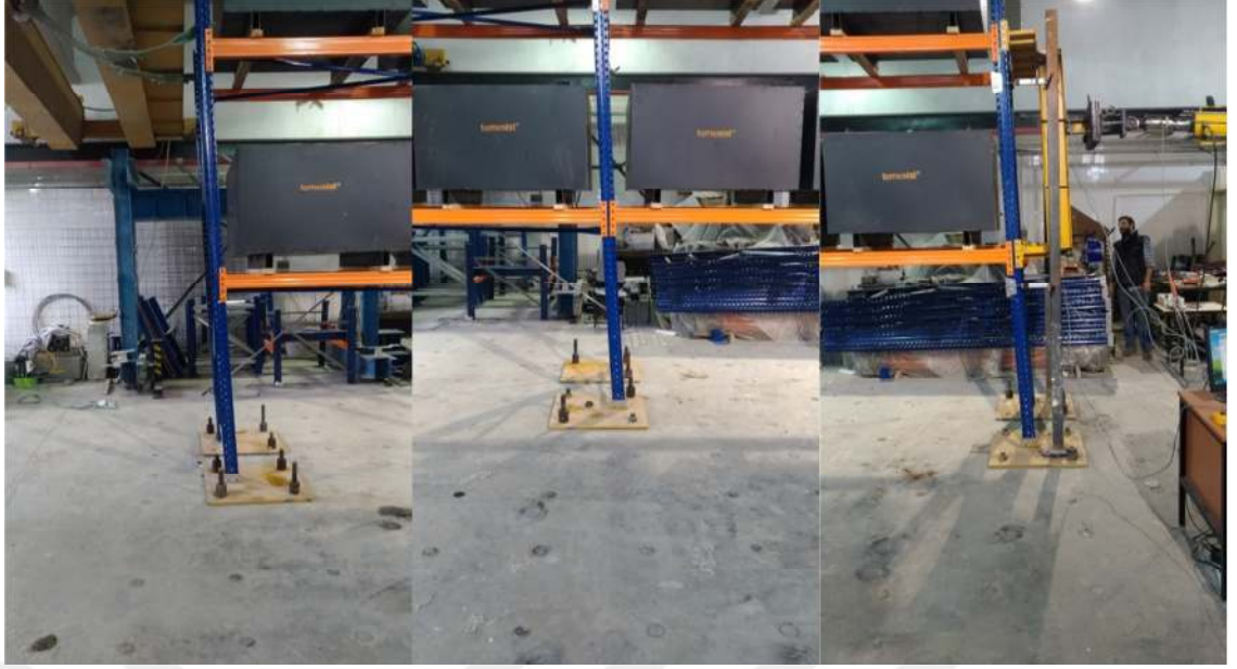
Şekil 4.8. Statik Gergili model deforme olmuş görünümü
