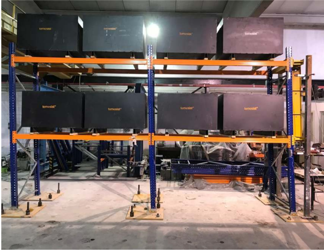
Şekil 4.2. Çaprazsız model deney öncesi genel görünüm
