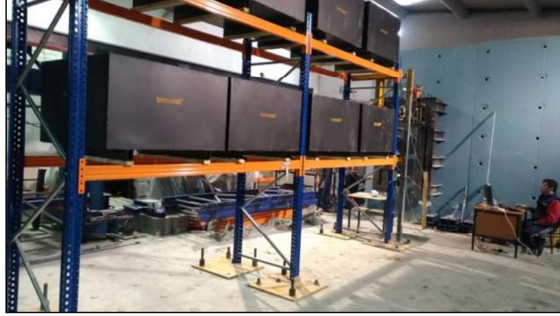
Şekil 3.19. SM1/DM1 Çaprazsız model genel görünüm
