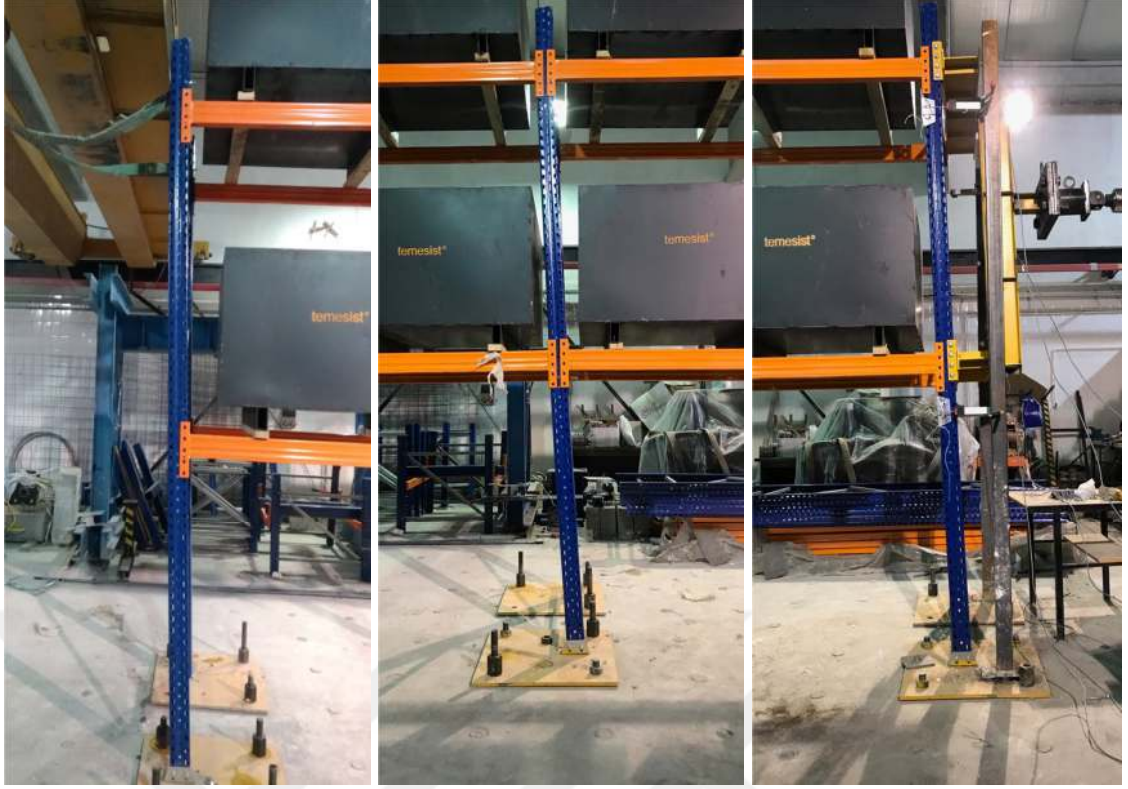
Şekil 4.3. Çaprazsız model deforme olmuş görünümü
