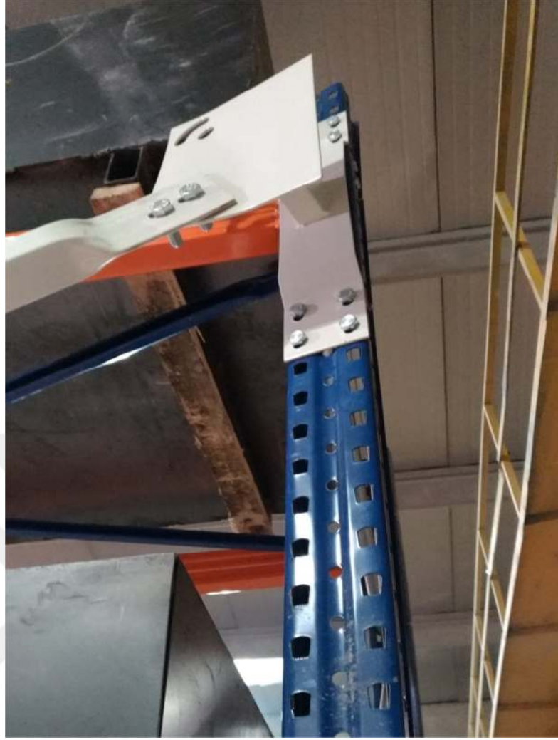
Şekil 4.14. Deprem Çaprazlı model deforme olmuş görünümü
