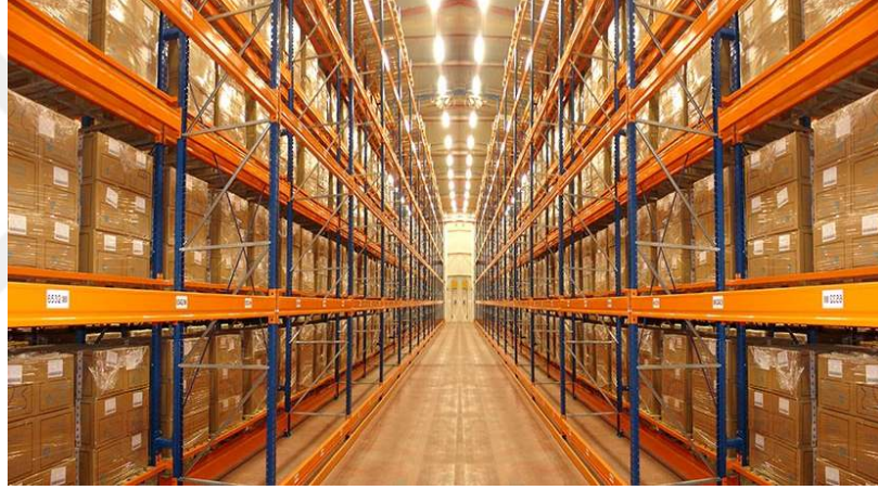
Şekil 1.1. Sırt sırta raf sistemi görünüm
