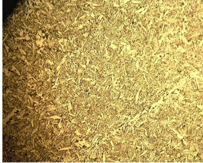
Şekil 6.12. Kaynak metalinde asiküler ferrit yapı (x70).
