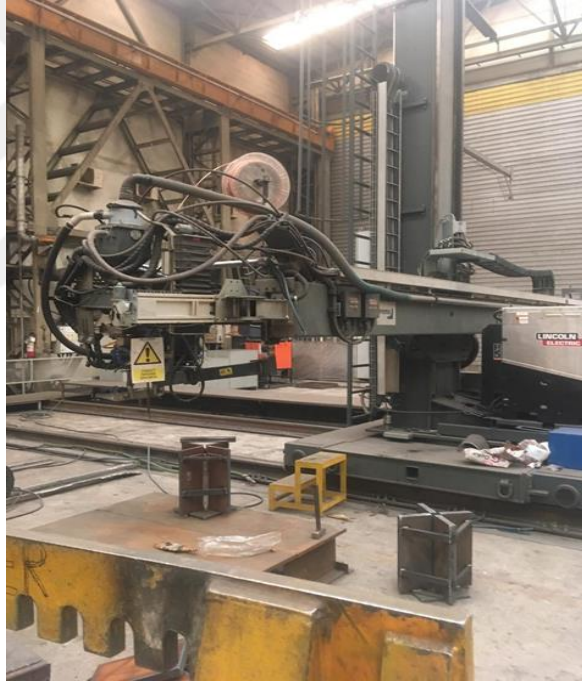
Şekil 4.2. Kalın kesitli malzemenin elektrocuruf kaynağı ile birleştirilmesi.
