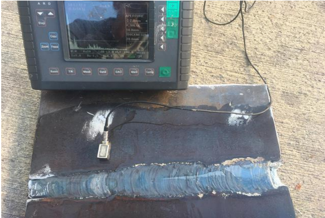
Şekil 6.1. Ultrasonik kontrol cihazı ile testlerin gerçekleştirilmesi.
