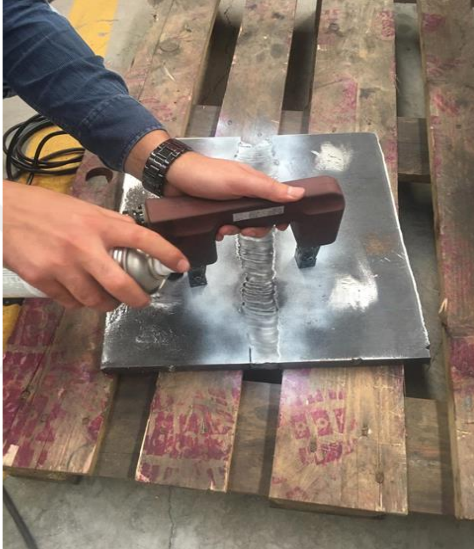
Şekil 6.2. Manyetik kontrol cihazı ile testlerin gerçekleştirilmesi.
