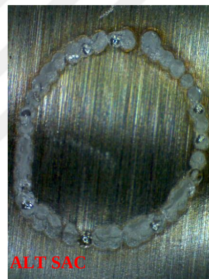
Şekil 5.24. AISI 304 malzemenin kopma görüntüsü a) üst sac b) alt sac.
