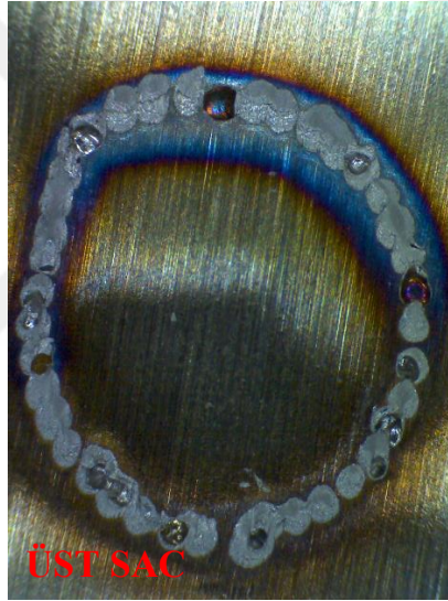
Şekil 5.24. AISI 304 malzemenin kopma görüntüsü a) üst sac b) alt sac.
