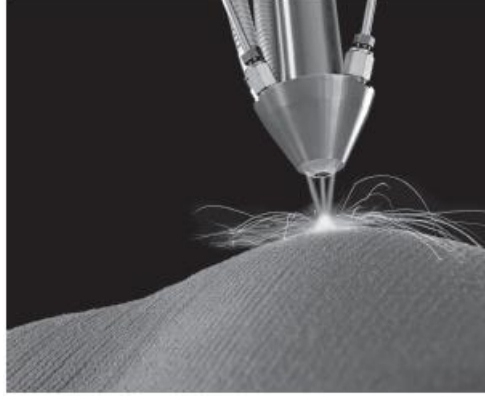
Şekil 3.6. Lazer ışının malzeme yüzeyine etki bölgesi [60].
