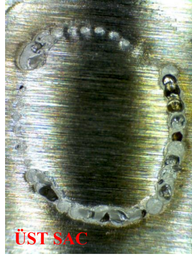
Şekil 5.24. AISI 304 malzemenin kopma görüntüsü a) üst sac b) alt sac.
