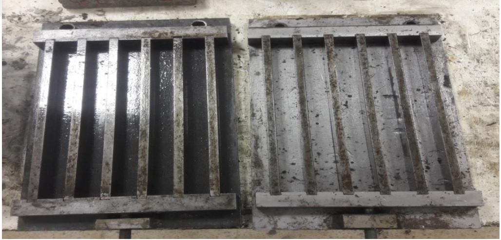
Şekil 3.12. 25x25x285 mm boyutlarındaki kalıp
