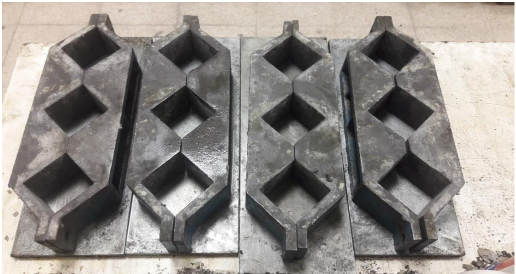
Şekil 3.13. 50x50x50 mm boyutlarındaki kalıp
