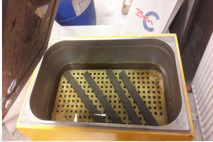
Şekil 3.20. ASR kür havuzu
