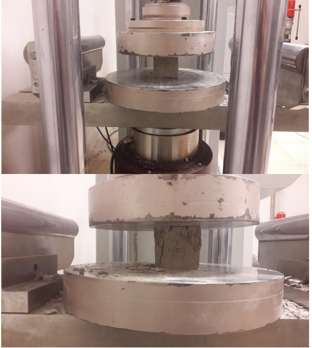
Şekil 3.23. Yüksek sıcaklık sonrası numunelerin dayanım testi
