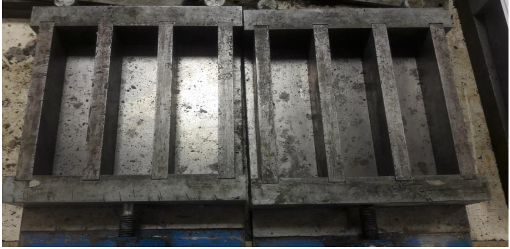
Şekil 3.11. 40x40x160 mm boyutlarındaki kalıp
