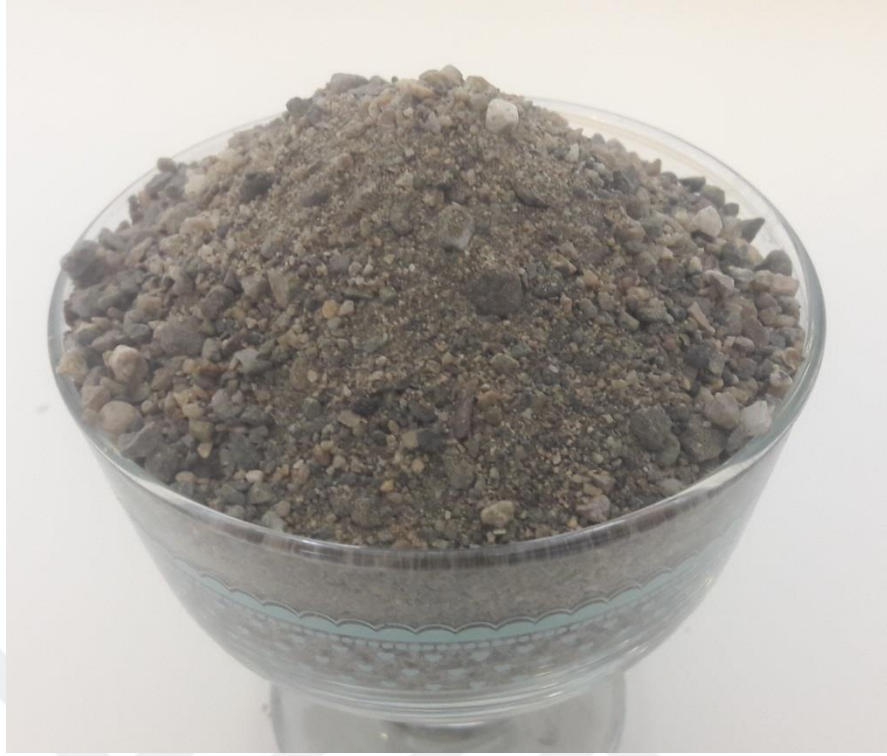
Şekil 3.10. 0-4 mm aralığında agrega (kum)
