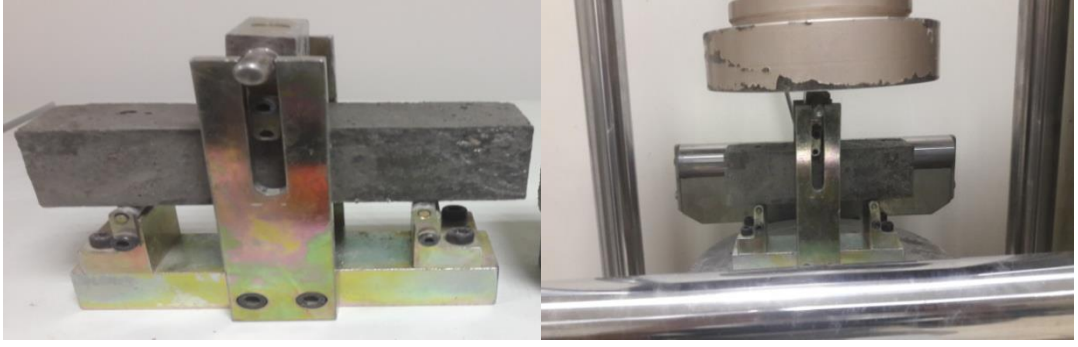
Şekil 3.16. Numunelerin basınç altında eğilme dayanımı testi
