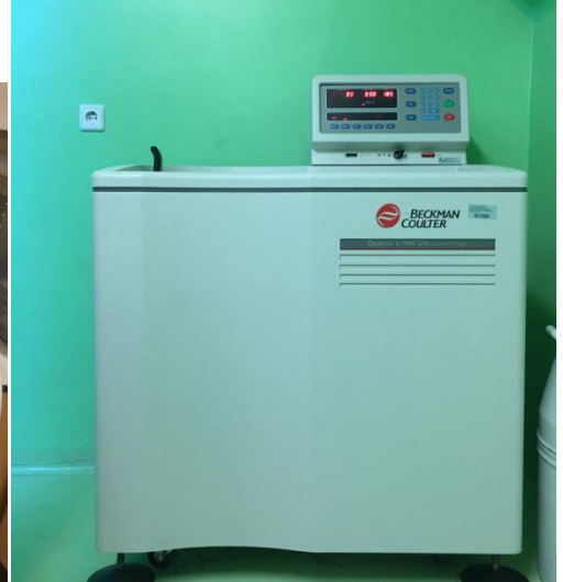
Şekil 3.23: Santrifüj işleminde kullanılan soğutmalı santrifüj ve ultrasantrifüj
