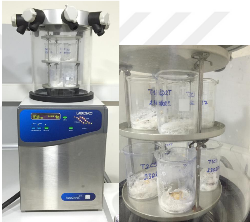
Şekil 3.7: Midye yumuşak dokularının liyofilizatörde kurutulması
