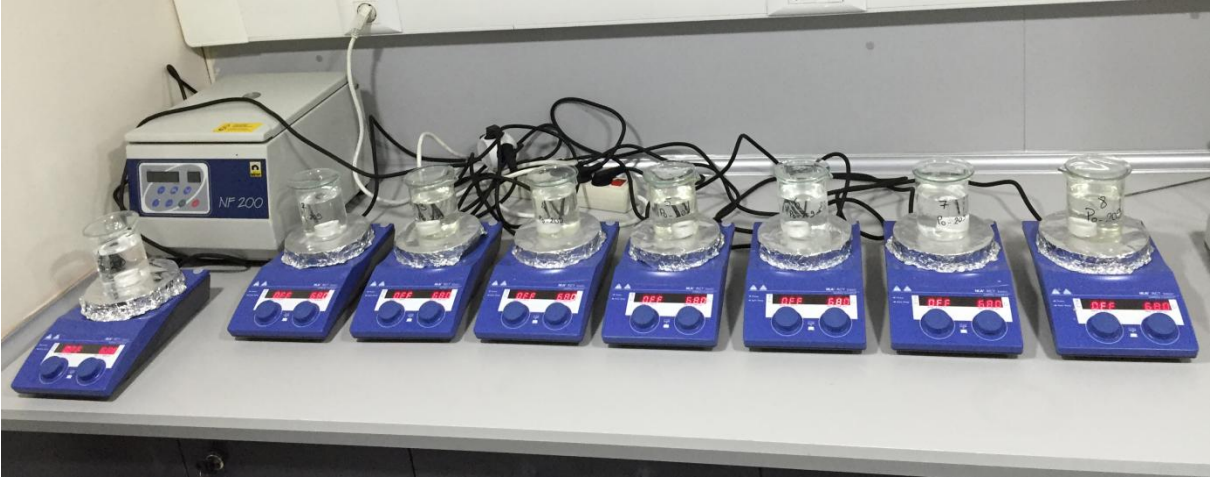
Şekil 3.9: Örneklerin gümüş disklere deposizyonu.
