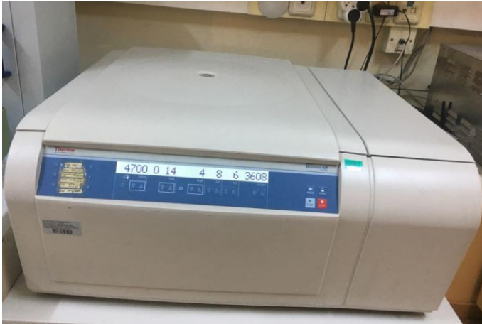
Şekil 3.23: Santrifüj işleminde kullanılan soğutmalı santrifüj ve ultrasantrifüj
