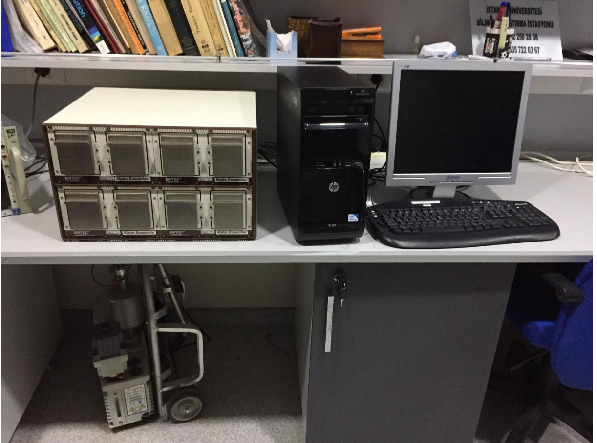
Şekil 3.11: Po-210 ölçümlerinin yapıldığı alfa spektrometresi.
