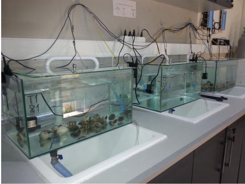
Şekil 3.4: Üç farklı pH değerinde deniz suyu ile doldurulmuş akvaryumlarda bulunan kum midyeleri ( Ruditapes philippinarum ).
