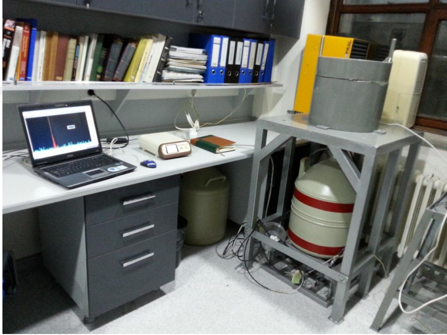
Şekil 3.17: Yüksek Saflıkta Germanyum (HPGe) dedektörlü gama spektrometresi.
