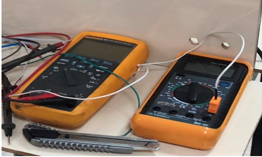
Şekil 5.4. Deneylerde kullanılan Datalogger
