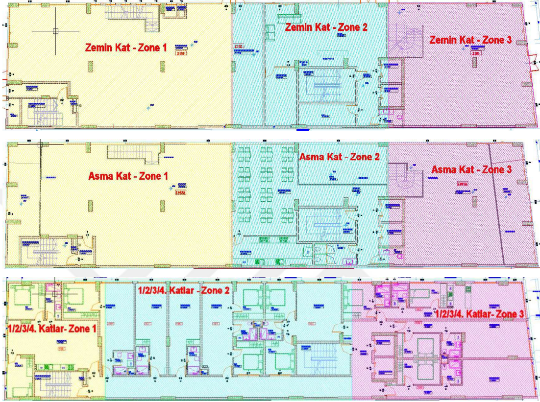
Şekil 7.3. Katlara ait enerji modellemede zonlama
