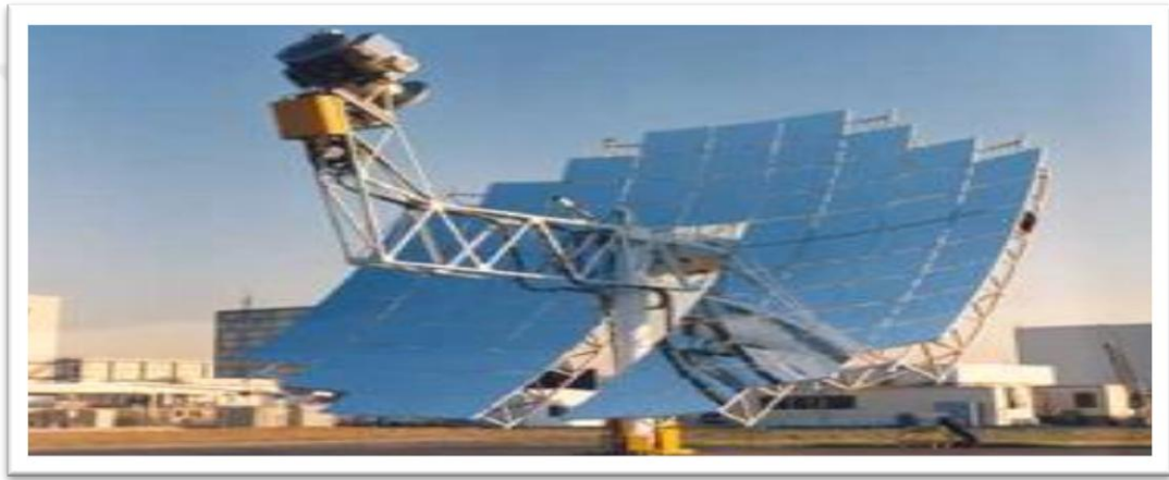
Şekil 2.7. Parabolik Çanak Kolektörlerin Yapısı
