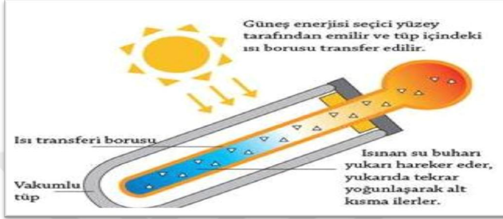
Şekil 2.5. Vakumlu Güneş Kolektörleri Yapısı
