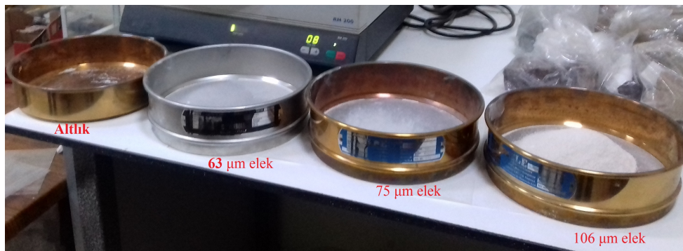
Şekil 3. 6. Üç farklı delik boyutundaki elekler
