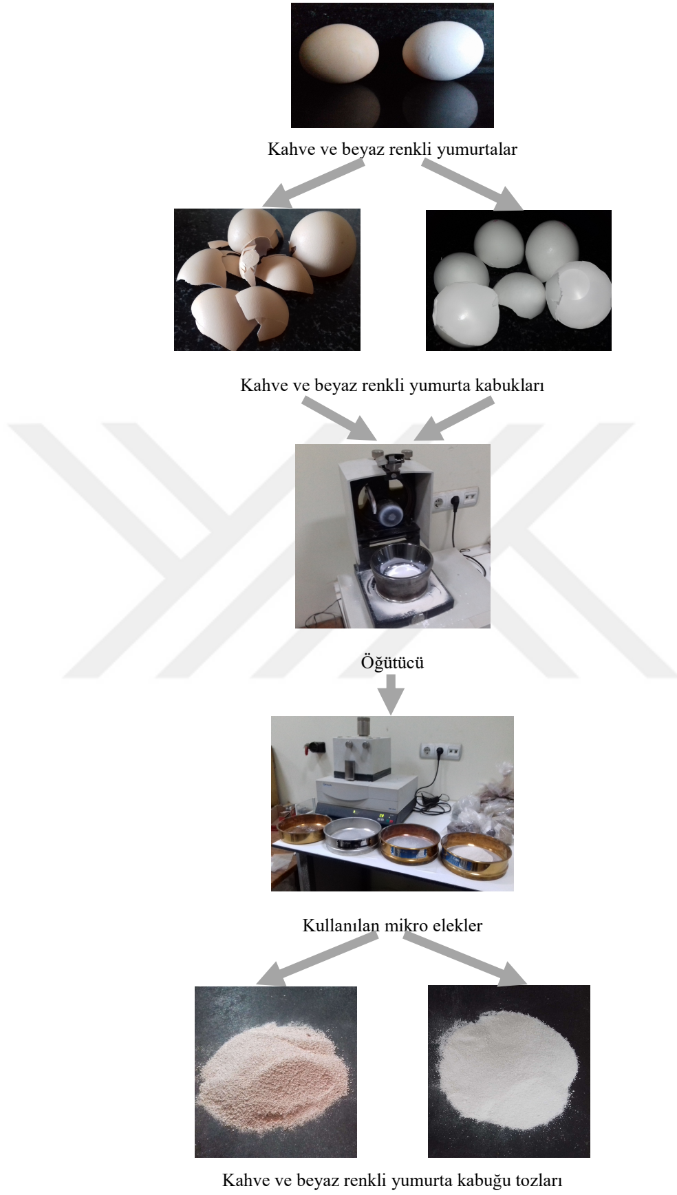
Şekil 3. 7. Beyaz ve kahverengi yumurta kabuğu tozlarının elde edilme aşamaları
