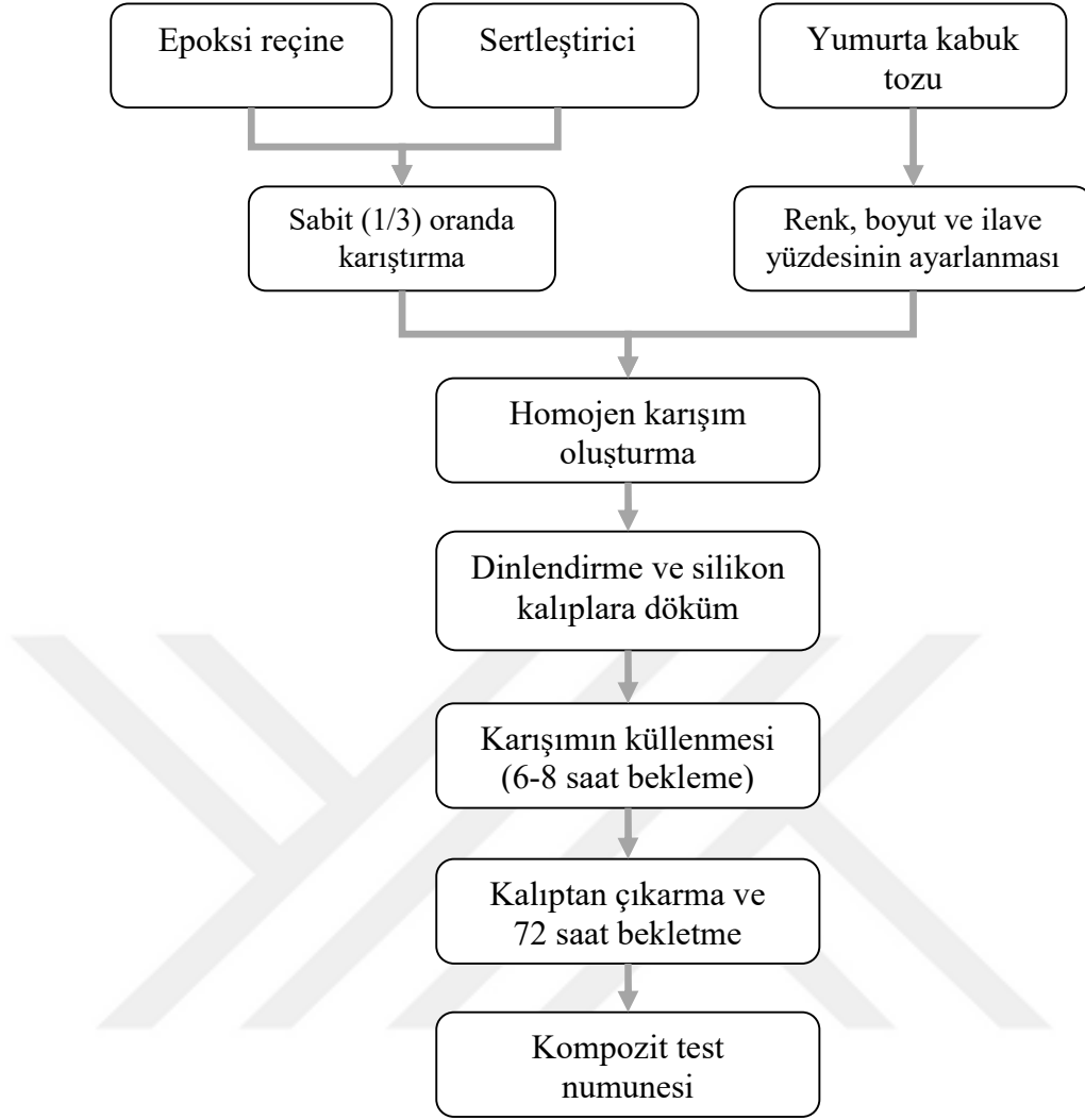
Şekil 3. 9. Kompozit numune üretim akış şeması
